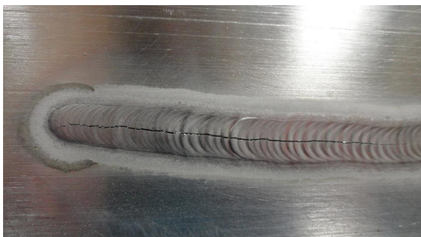
Figura 34 - Fratura de cordão de soldadura pelo eixo central [39]
