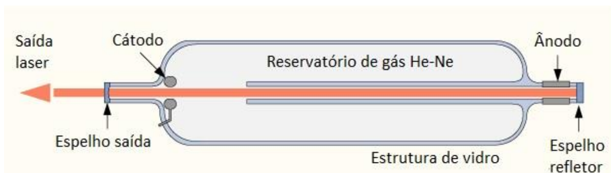
Figura 21- Constituição e funcionamento esquemático do laser He-Ne (adaptado de [32])
