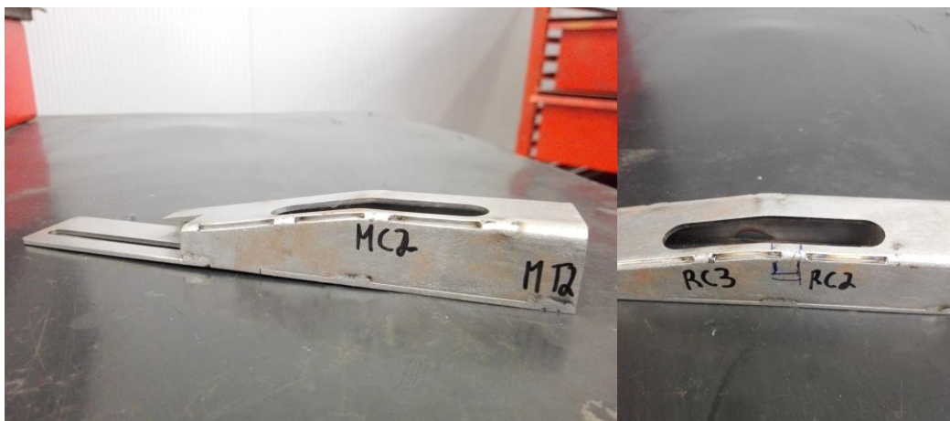
Figura 68 – Marcação das zonas de corte nos conjuntos 0657669 e 0657670
