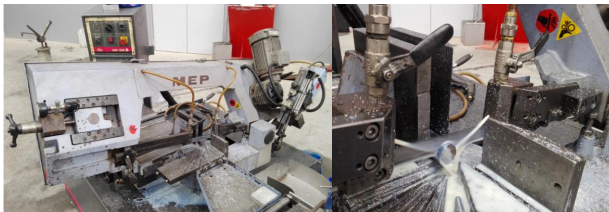
Figura 52 - Serrote Shark 330 HH, fabricante MEP, na empresa Quantal S.A. (esquerda); lubrificação durante operação de corte (direita)
