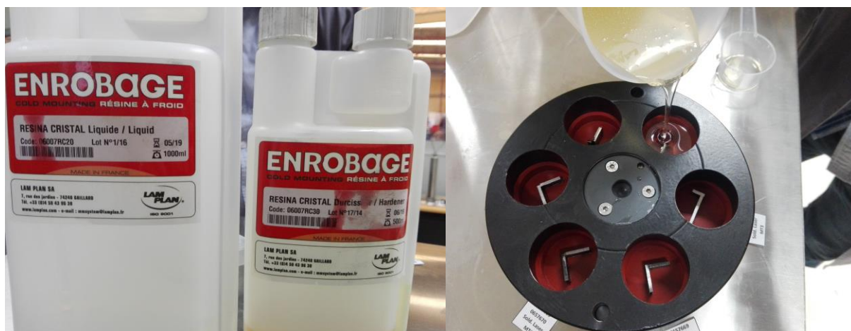
Figura 79 – Tipo de resina e endurecedor para realizar a mistura (esquerda); vazamento da mistura para o suporte de solidificação (direita)
