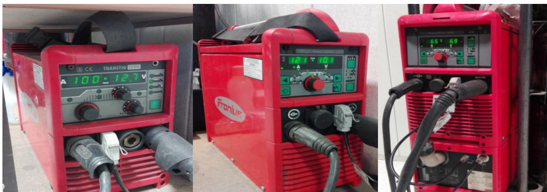
Figura 46 - Equipamentos de soldadura TIG utilizados para soldar amostras na empresa Quantal S.A. Fronius Transtig 1700 (esquerda), MagicWave 2200 (centro), MagicWave 3000 (direita)
