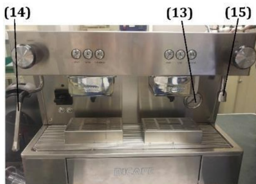
Figura 27 Identificação dos componentes do módulo de vapor de água e água quente, na vista frontal da máquina: (13) manómetro, (14) saída de vapor de água e (15) saída de água quente.
