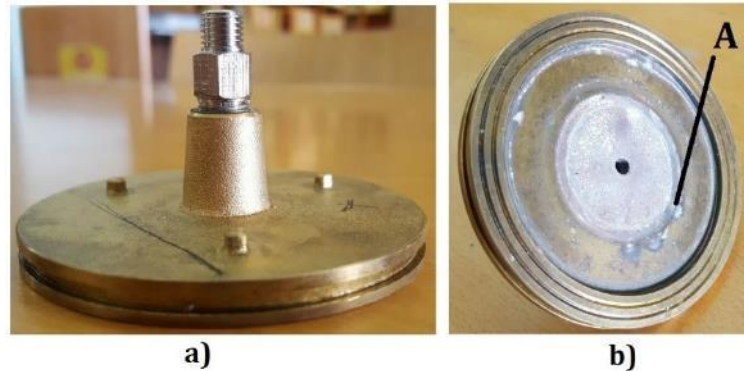
Figura 82 Placa permutadora de calor; a) placa permutadora de calor vista da parte superior; b) parte inferior da placa permutadora de calor com destaque para a presença de algum calcário e corrosão (A).
