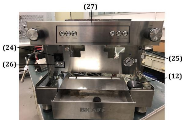
Figura 42 Vista frontal da máquina, parcialmente desmontada, com identificação do copo de esgoto (12), do botão rotativo de três posições (24), do botão ON/OFF (25), dos botões do grupo (26) e dos botões de seleção do tamanho do café (27).
