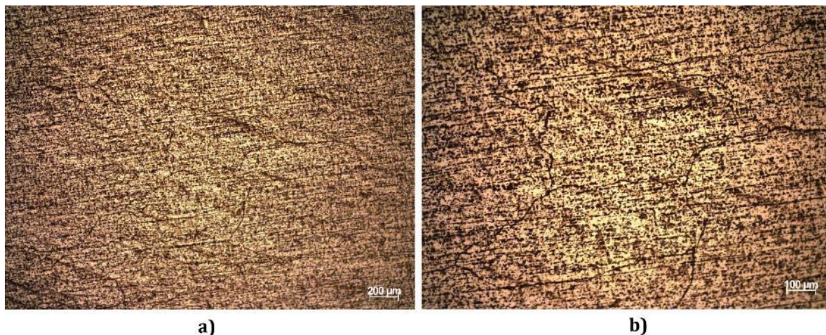
Figura 81 Microestruturas da amostra do aro, sendo visível vários cristais de solução sólida de alumínio, com grandes dimensões, orientados na direção da extrusão. Reagente: Poulton's ; a) objetiva de 5X; b) objetiva de 10X.
