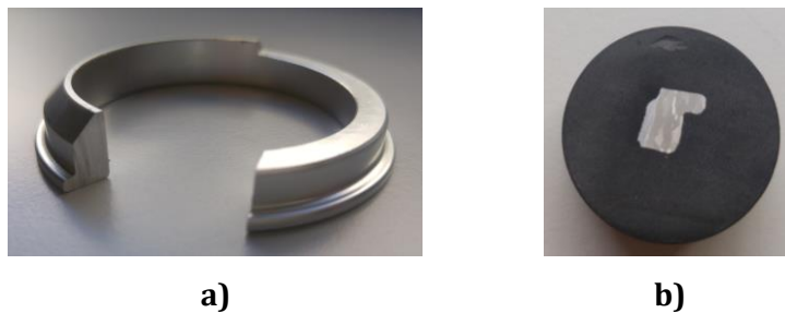
Figura 80 Aro metálico seccionado e respetiva amostra; a) aro seccionado; b) amostra para analisar ao microscópio.
