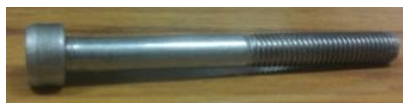
Figura 123 Parafuso CHC ISO 4762 - M5 x 50, que garante a fixação do termobloco à base metálica de suporte do grupo.
