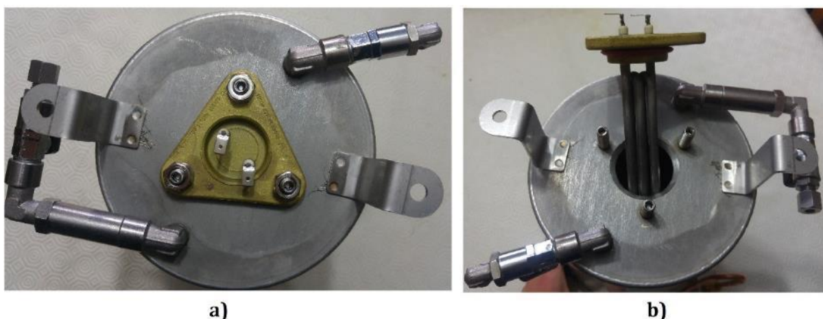
Figura 29 Vista de baixo da caldeira (3); a) vista de baixo inicial com todos os componentes montados; b) desmontagem da resistência.
