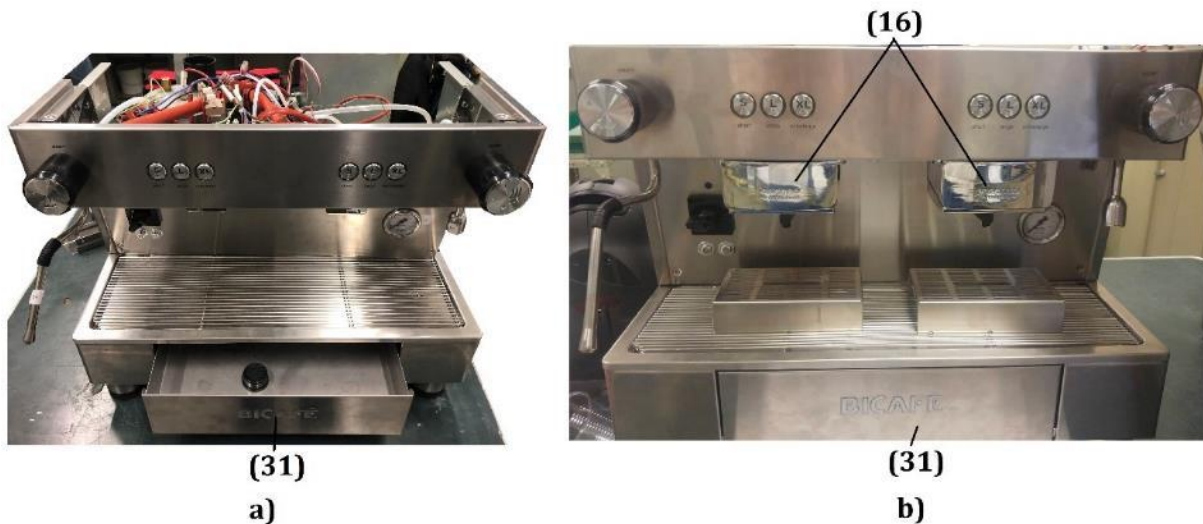
Figura 36 Vistas frontais da máquina com indicação das gavetas; a) (31) gaveta que recolhe as cápsulas usadas aberta; b) identificação das gavetas de colocação das cápsulas nos grupos (16) e da gaveta que recolhe as cápsulas usadas (31). Ambas estão fechadas.
