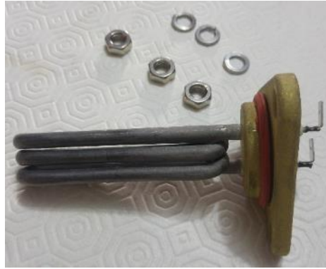
Figura 30 Resistência da caldeira (3) com a presença das três porcas M8 e das três anilhas, que garantem o seu posicionamento à caldeira (3). A resistência funciona a 230V e tem uma potência de funcionamento de 1200W.
