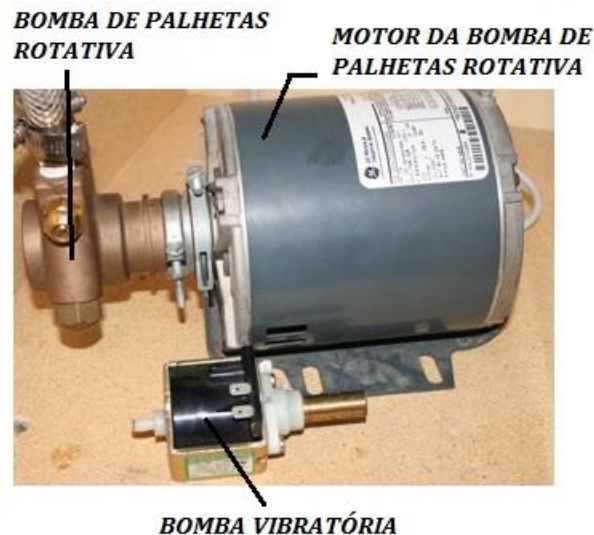
Figura 19 Bomba rotativa de palhetas com o motor acoplado e bomba vibratória, lado a lado – adaptado de [48].
