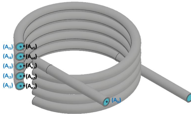
Figura 102 Tubo da água seccionado, com o modelo fluídico no seu interior, para a identificação dos pontos considerados na análise do aquecimento da água: (A i1 ) ponto no interior da água do patamar 1 (nó 91680), (A i2 ) ponto no interior da água do patamar 2 (nó 91474), (A i3 ) ponto no interior da água do patamar 3 (nó 93635), (A i4 ) ponto no interior da água do patamar 4 (nó 93179) e (A i5 ) ponto no interior da água do patamar 5 (nó 94885); (A e1 ) ponto no exterior da água do patamar 1 (nó 1368), (A e2 ) ponto no exterior da água do patamar 2 (nó 1566), (A e3 ) ponto no exterior da água do patamar 3 (nó 1764), (A e4 ) ponto no exterior da água do patamar 4 (nó 1962) e (A e5 ) ponto no exterior da água do patamar 5 (nó 2160); (A is ) ponto no interior da água à saída (nó2317).
