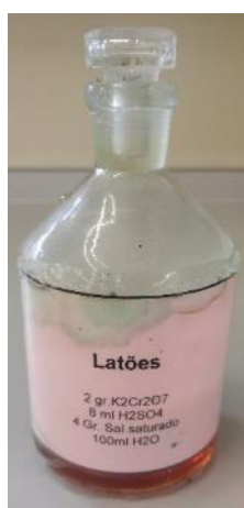
Figura 125 Reagente utilizado nas peças em latão.
