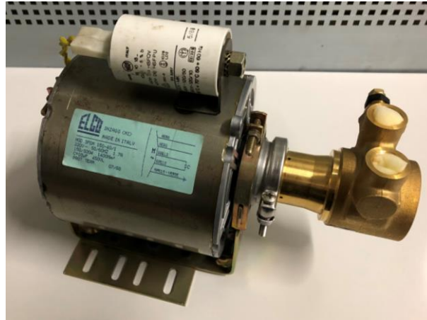
Figura 117 Conjunto motor e bomba rotativa selecionados para a nova máquina.
