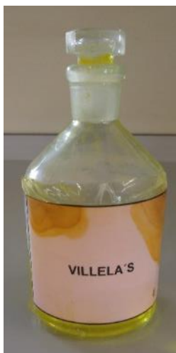
Figura 126 Reagente Villela's utilizado na amostra da mola do êmbolo.
