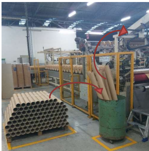
Figura 33 - Pallet de tubos, carrinho e escadote usado no reabastecimento de tubos
