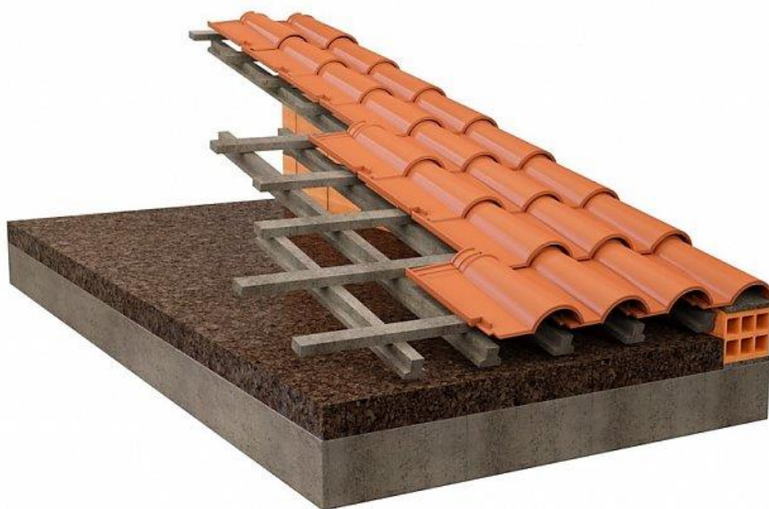
Figura 5.9 – Pormenor construtivo de telhado de telha sob a laje de cobertura do Wc da sala. [28]
