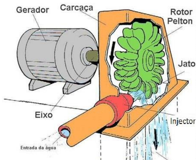
Figura 3.4 - Funcionamento de uma pequena turbina Pelton com eixo horizontal
