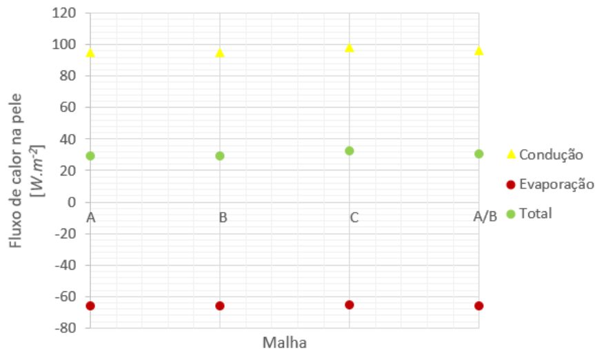
Figura 20. Representação gráfica do fluxo de calor na pele, \dot{q} , em W.m^{-2} , em função dos tipos de malha considerados (estudos 14, 15, 16 e 17 da Tabela 2)
