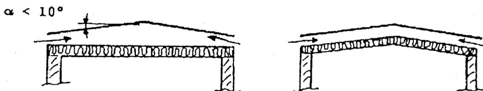
Figura 5.7 – Princípio de ventilação de coberturas com inclinação inferior a  $10^\circ$ , segundo a DIN 4108 [51]
