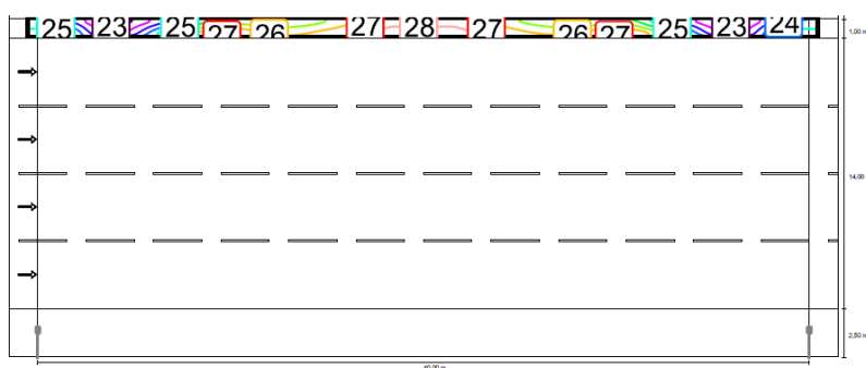
Figura 6.22: Potência luminosa na pista de acostamento à esquerda do utilizador da pena via do Nó de Custóias com as luminárias atuais (VSAP)
