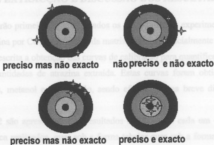
Figura 4.5 – Representação gráfica da precisão e exactidão [adaptado de (Bretti,2000)].
