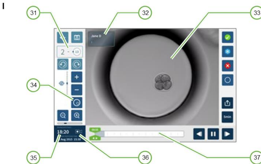
Figura 17- Representação da interface apresentada na seleção e ampliação de um determinado micro-poço de uma câmara de incubação. Para além da devida identificação do micro-poço correspondente com o nome da paciente em questão (I31 e 32, respetivamente), uma imagem ampliada do embrião pode ser obtida, de forma a visionar todas as etapas de desenvolvimento do mesmo, tanto pelo manuseio, para a esquerda (retrocesso) ou direita (avanço) da barra temporal indicada com a letra e número I37. O tempo inicial de inseminação é apresentado na barra azul escura do canto inferior esquerdo (I36) e o tempo total de captação de imagem, desde o início da captação de imagens associadas ao desenvolvimento do embrião em questão, é, igualmente, indicado (I35), de modo a que o embriologista acompanhe todos os momentos em pormenor e conheça a etapa de desenvolvimento em que o embrião se encontra em cada momento. Para embriões avaliados pela opção Eeva test , o tipo de microscopia correspondente é de campo escuro, pelo que esta opção terá de ser selecionada para estes casos em específico (I34). Adaptado de Genea BIOMEDX.
