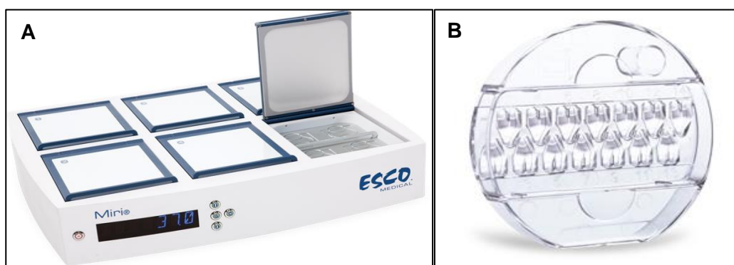
Figura 10- Sistema time-lapse Miri® (A) e representação dos respetivos poços de cultura, Culture Coin (B). Imagem A e B disponíveis em http://medical.escoglobal.com . Acedido a 7 de setembro de 2017.
