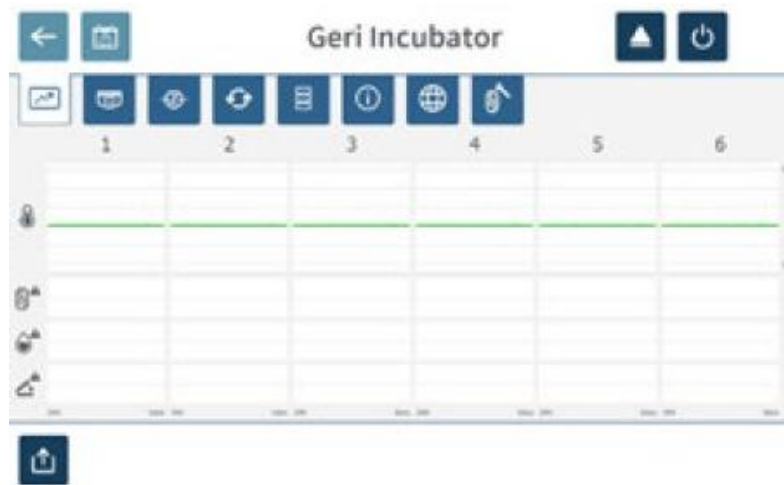
Figura 12- Interface acedida a partir do ecrã principal do sistema de laboratório Geri+, com disponibilidade de várias funções, desde o acesso às condições atmosféricas em cada câmara individual até à opção de extração de dados relativos a um caso desejado de uma câmara à escolha. Adaptado de Genea BIOMEDX.
