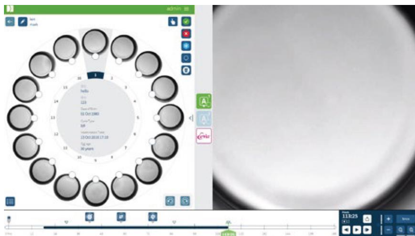
Figura 19- Representação da interface de acesso a cada câmara de incubação e micro-poços correspondentes pelo Geri Connect. Aquando da seleção desta opção em particular, o controlo de toda a captação de imagem do embrião é possível, apresentando, no canto inferior direito, todos os comandos para parar, pôr em pausa, visualizar frames antigos ou mais recentes na escala temporal (permitindo a alteração da frequência de captação de imagem em cinco, dez ou trinta minutos), alterar os planos de focagem, mudar para outros micro-poços e, ainda, exportar dados relativos às imagens do embrião selecionado no momento. Igualmente, a categorização dos embriões com base nos diferentes símbolos (cujo significado está expresso na secção “3.3.2.5. Acesso a cada câmara de incubação: observação e marcação do estado embrionário”) pode ser efetuada, também, com recurso a esta parte integrante. Adaptado de Genea BIOMEDX.
