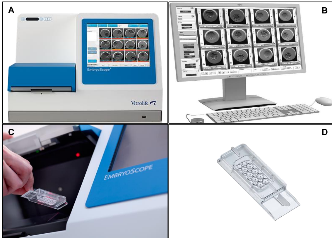
Figura 8- Sistema time-lapse EmbryoScope® (A), conjugado com o seu controlo computacional exterior ao aparelho de incubação (B). O EmbryoSlide (C e D), de diâmetro 0,2 mm e 25 \mu L de volume máximo de meio de cultura, apresenta uma pequena peça na parte final, a seguir aos poços, que permite que o utilizador segure e encaixe o sistema de poços de cultura com a máxima segurança e cuidado (C). Imagem A disponível em http://www.vitrolife.com . Imagem B adaptada de Best, 2015. Imagem C e D disponíveis em http://www.vitrolife.com . Acedido a 7 de setembro de 2017.
