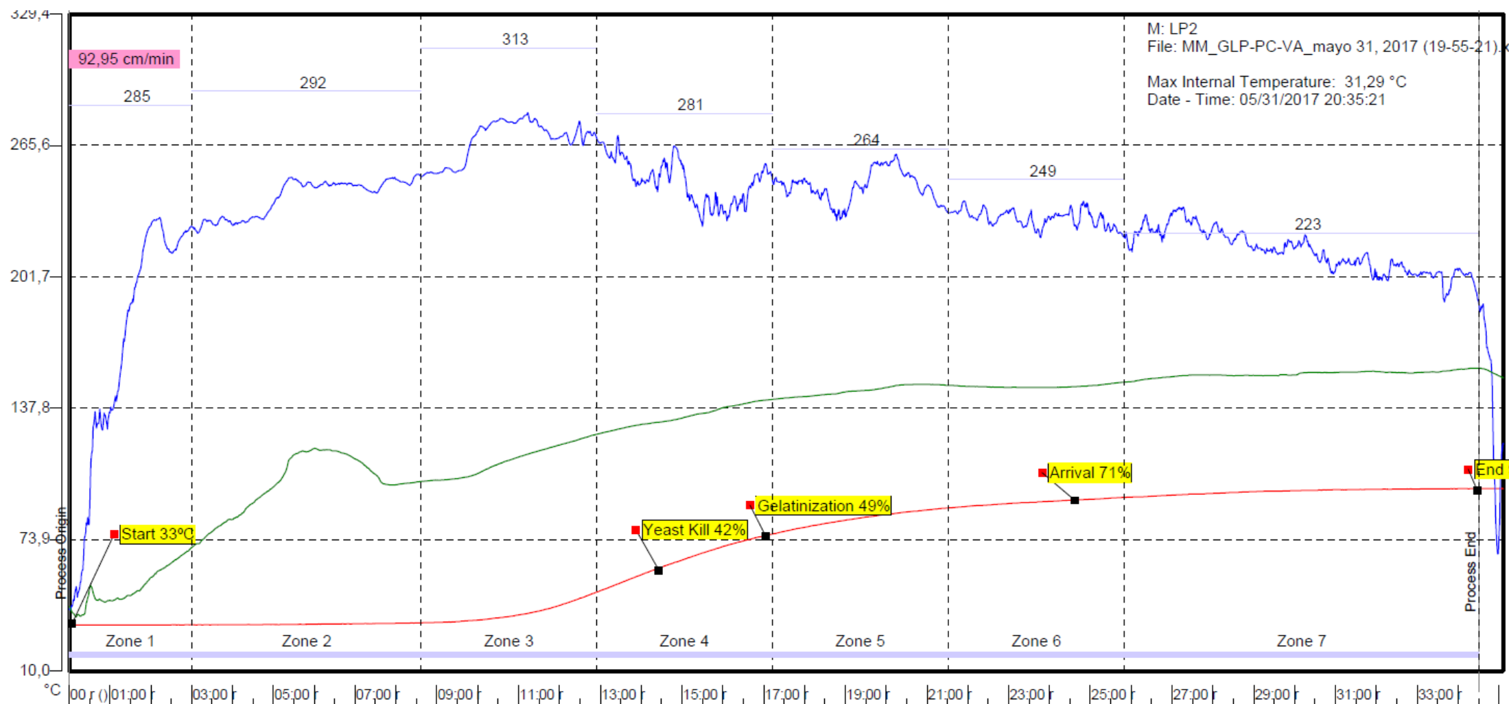
Figura 4. Acompanhamento das temperaturas interior do forno (gráfico azul), da superfície do pão (gráfico verde), e no centro do produto (gráfico vermelho), através da utilização de um Datalogger, obtido na Empresa
