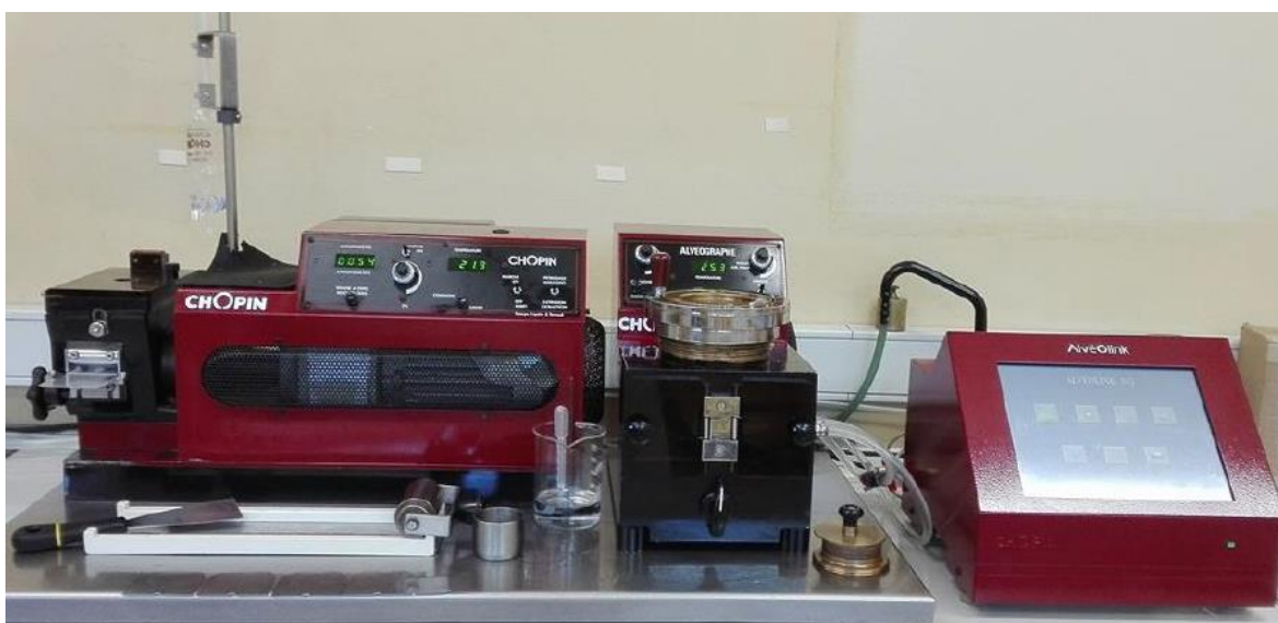
Figura 14. Alveógrafo de Chopin
