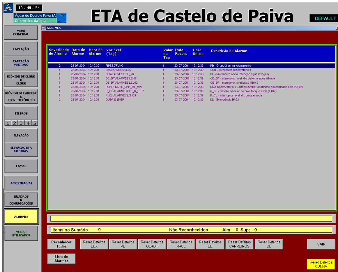
Figura 4-8 Exemplificação: listagem de alarmes (sinóptico alarmes).
