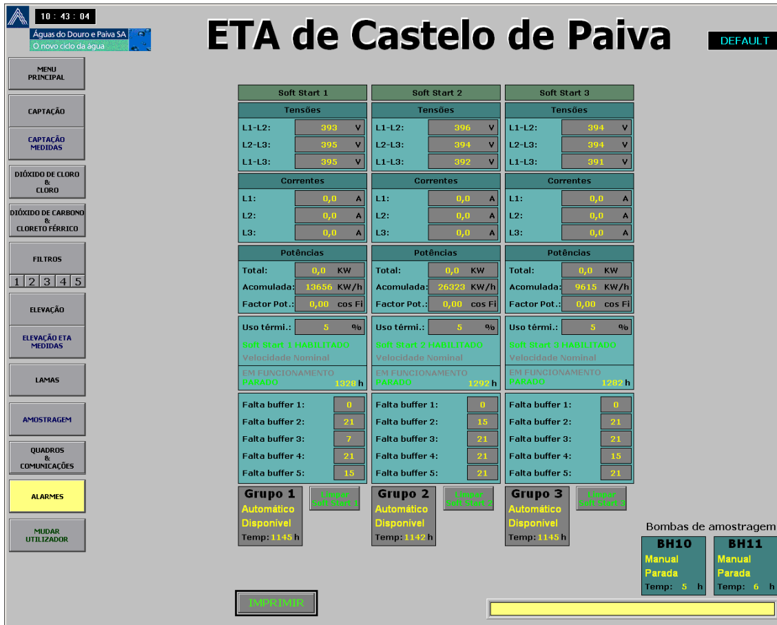
Figura A-11 Sinóptico Elevação ETA Medidas.
