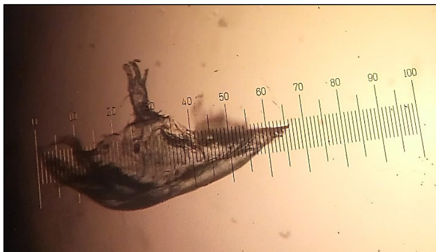
Figura 19. Medição dos MPs encontrados por microscopia.
