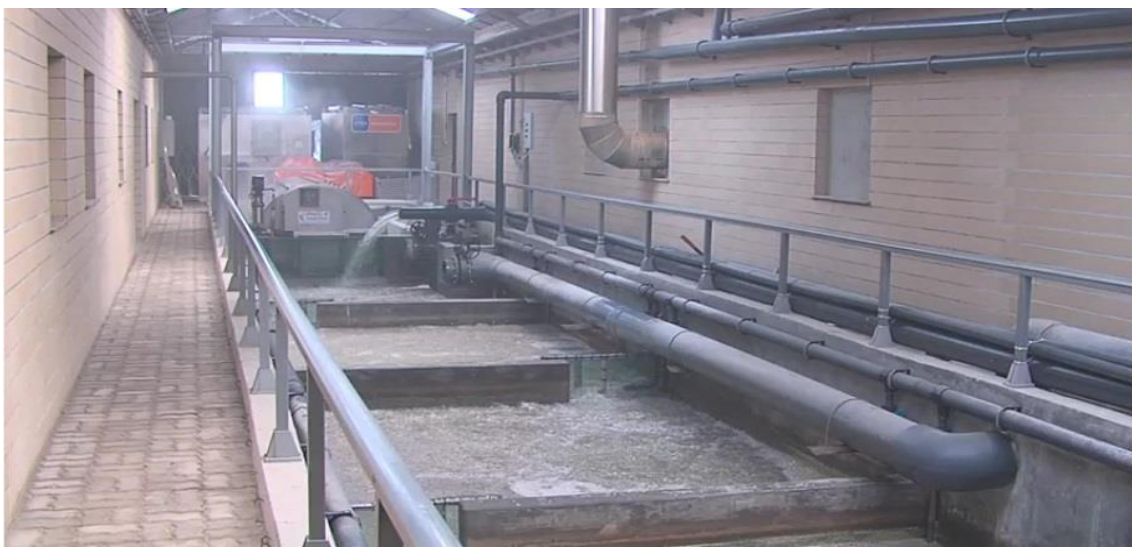
Fig. 25 – Biofiltro móvel utilizado na Safiestela (Sea8)
