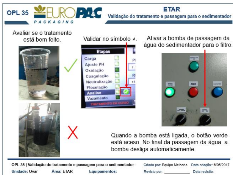
Figura 52 – OPL “Validação do tratamento e passagem para o sedimentador”
