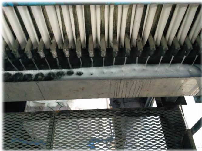
Figura 43 - Espuma branca à saída do filtro de prensa
