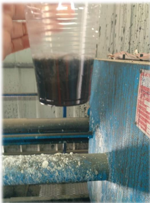
Figura 42 - Água tratada com resíduos de tinta
