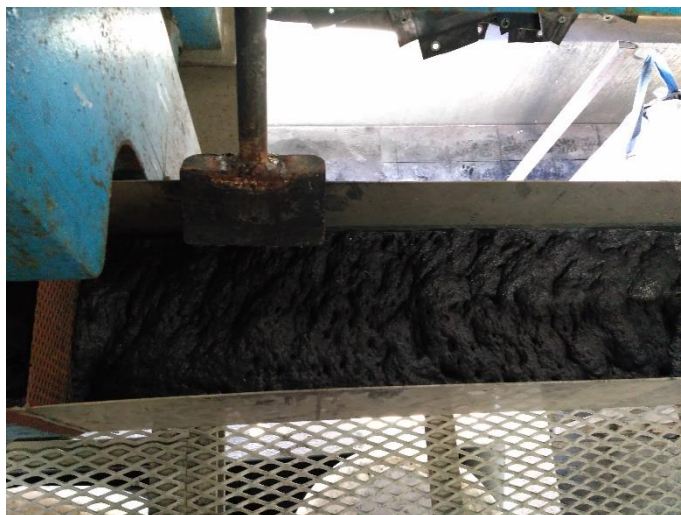
Figura 44 - Espuma preta à saída do filtro de prensa
