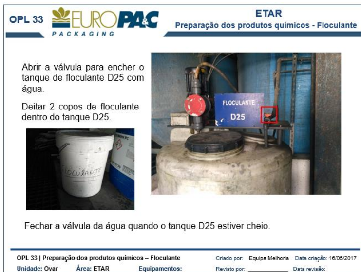
Figura 50 - OPL "Preparação dos produtos químicos - Floculante"
