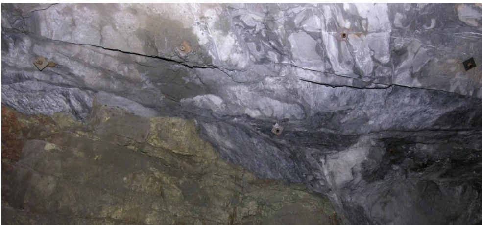
Figura 66 - Parafusos de Resina aplicados num teto de uma galeria de exploração
