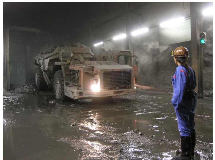
Figura 55 – Descarregamento na britagem de um Dumper carregado de minério
