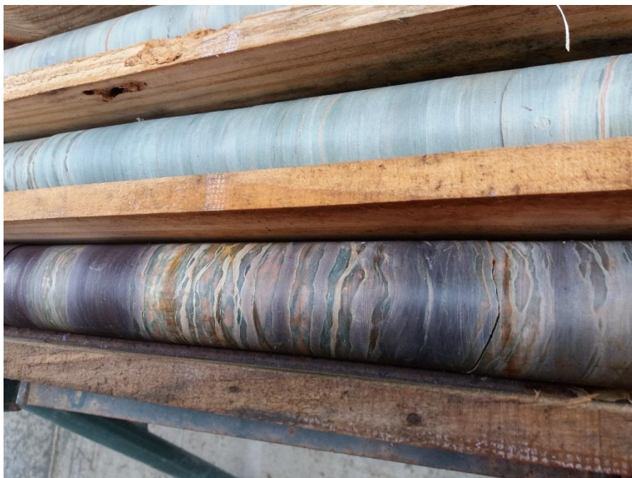
Figura 41 - Exemplo de testemunho de sondagem
