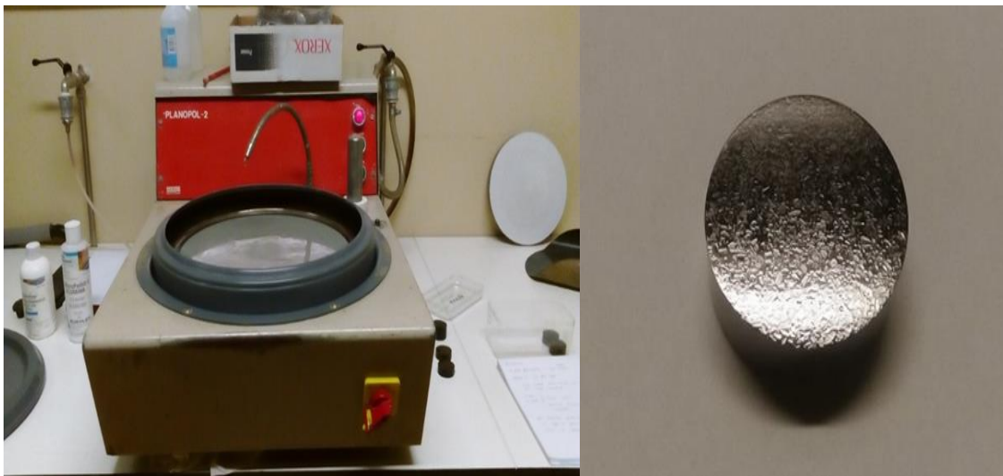
Figura 11 - Equipamento de polimento Struers, Planopol (esquerda); aspeto da amostra polida (direita).
