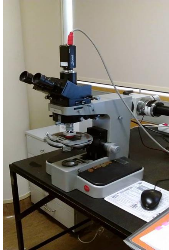
Figura 13 - Microscópio Leitz Wetzlar acoplado a um sistema de hardware usando o software Fossil pertencente ao DGAOT – FCUP.
