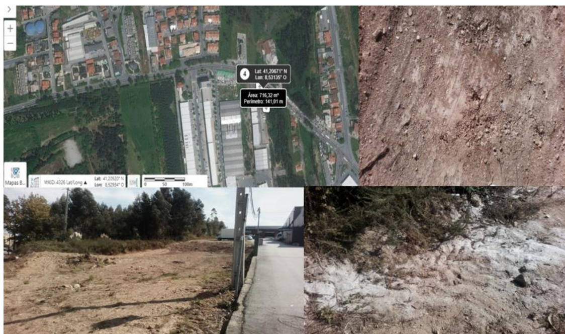
Figura 9. Fotografias e informações caracterizadoras para o Passivo Ambiental - sucata 10; 1 – localização do passivo, com coordenada e respectiva área (retirado do SIG municipal); 2 – tipo de solo - xisto luzente; 3 – vegetação cortada após visita caracterizadora; 4 – presença de lâ de rocha; (Fonte - Autor).
