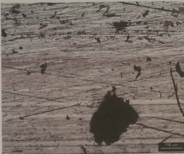
Figura 4.19 – Fotos recolhidas da superfície barra de CK 45 do ensaio de 24 horas, à esquerda com ampliação de 50 x e à direita com ampliação de 100 x.
