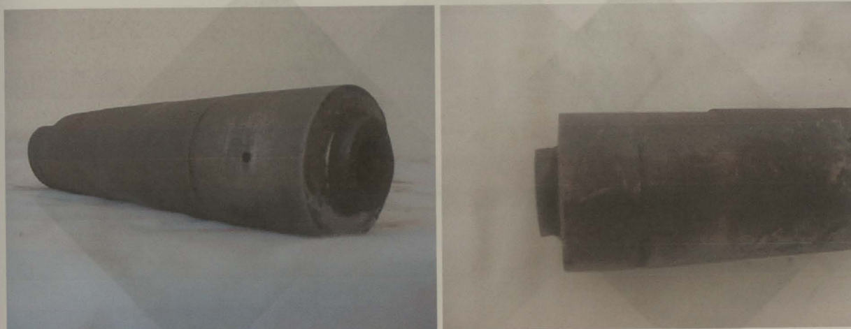
Figura 3.4 – Cavilhão. A sua extremidade exterior funciona como eixo de rotação dos roletes.
