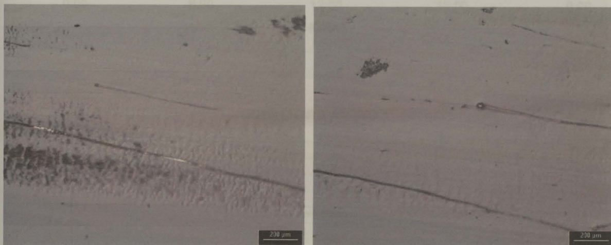
Figura 4.16 - Fotos da superfície do pino de poliamida após ensaio de 24 horas sobre St 52.3, ampliadas 50 x e 100 x, respectivamente.
