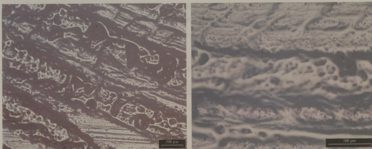
Figura 4.26 – Superfície do provete de poliamida, após 120 horas de ensaio, numa emulsão de água e óleo, à esquerda ampliada 50 x, e à direita 100 x, identificando-se os sulcos da maquinagem na superfície do provete, sendo pouco significativas as áreas com desgaste.
