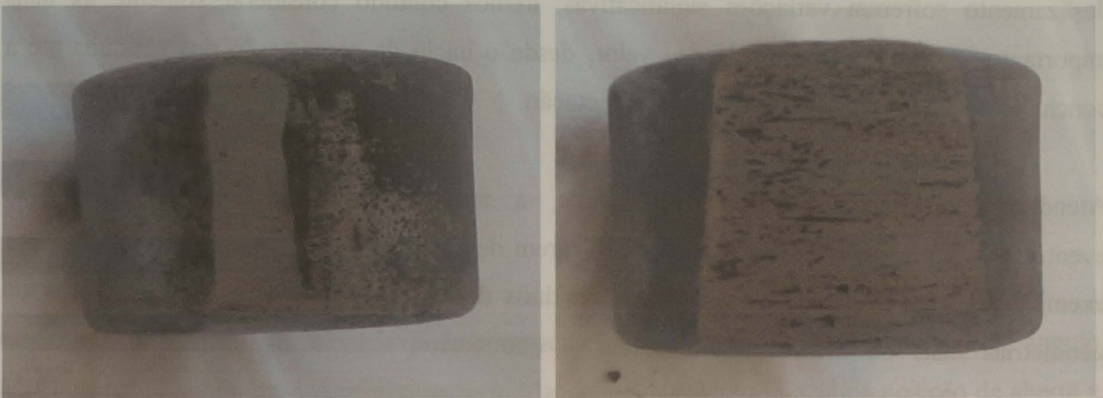
Figura 4.8 – Desgaste abrasivo. Degradação no contacto linear dos roletes devido aos esforços envolvidos e às condições de serviço.
