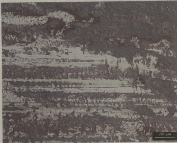
Figura 4.18 – Foto da superfície do pino de poliamida recolhida após o ensaio de 24 horas com CK 45, ampliada 50 x.
