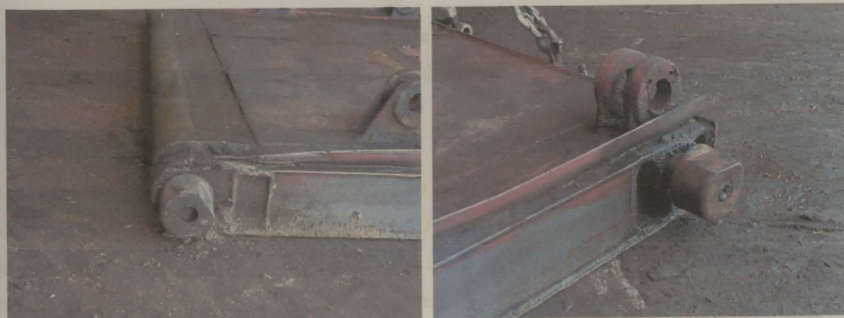
Figura 3.5 - Charriot desmontado da viseira, e sem a placa de compressão, mostrando o posicionamento dos roletes.
