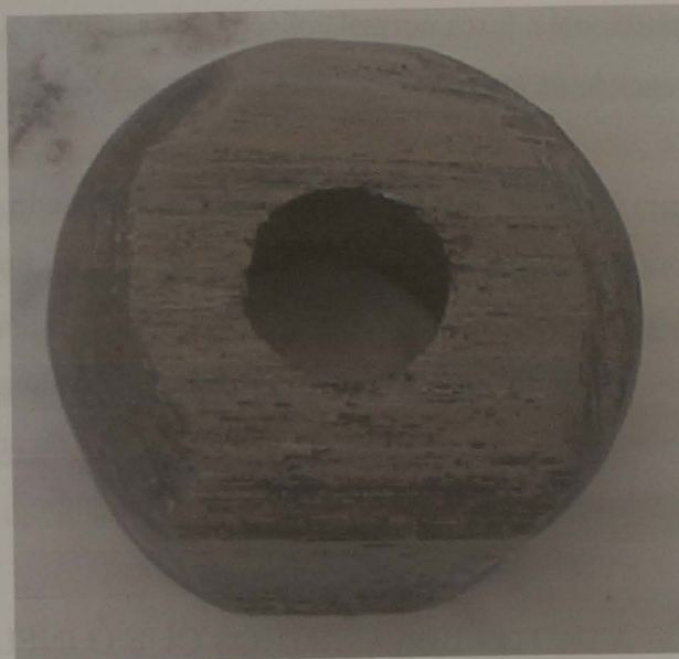
Figura 1.6 – Foto de um rolete retirado do serviço mostrando as estrias de desgaste por abrasão.
