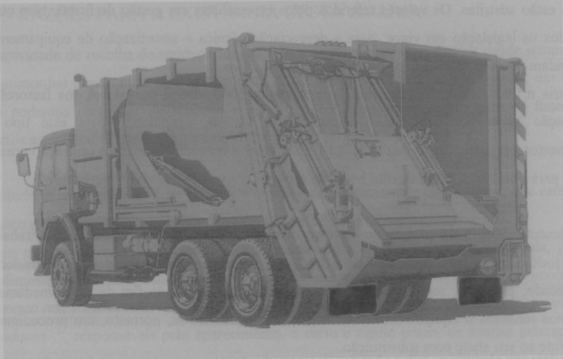
Figura 3.1 – Vista geral da superestrutura, em corte, duma viatura de R.R.S.U., mostrando o mecanismo de compactação.
