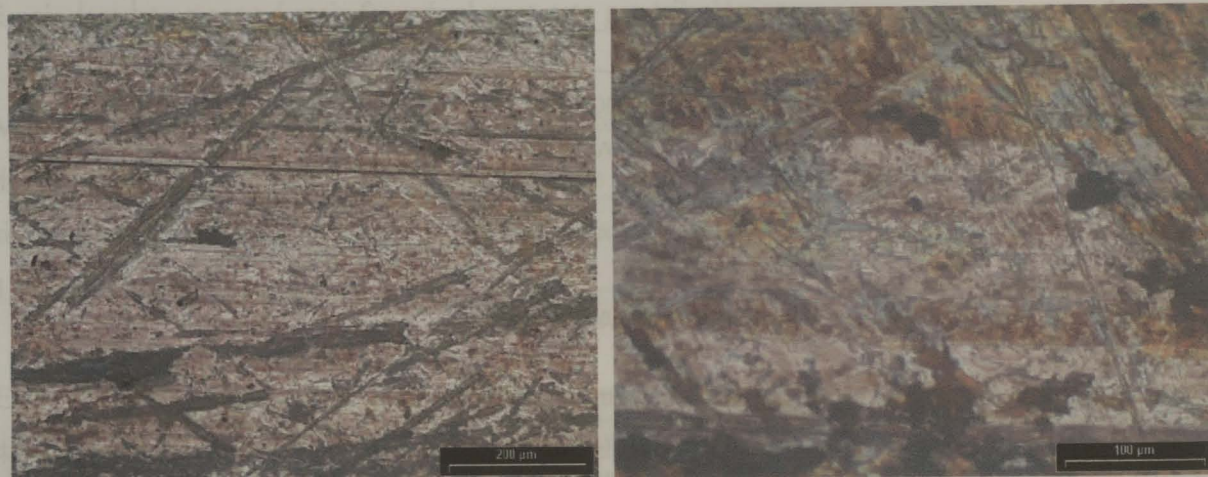
Figura 4.25 – Superfície da barra de CK 45, após 120 horas de ensaio, numa emulsão de água e óleo, à esquerda ampliada 100 x, e à direita 200 x, sendo ainda visíveis os sulcos da maquinagem do provete, e identificando-se as zonas do contacto na parte central de ambas as fotos.
