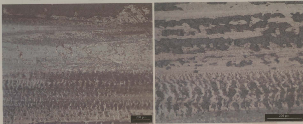
Figura 4.17 - Fotos da superfície do pino de poliamida após ensaio de 24 horas sobre St 52.3 polido, ampliadas 50 x e 100 x, respectivamente.
