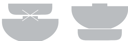
F.54 Visualização da Interferência da Pega na Arrumação
