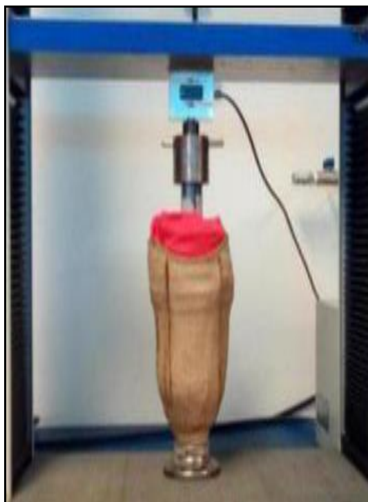
Figura 6.32 – Protótipo montado para ensaio de compressão
