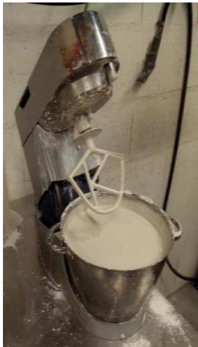
Figura 6.11 – Preparação do gesso
