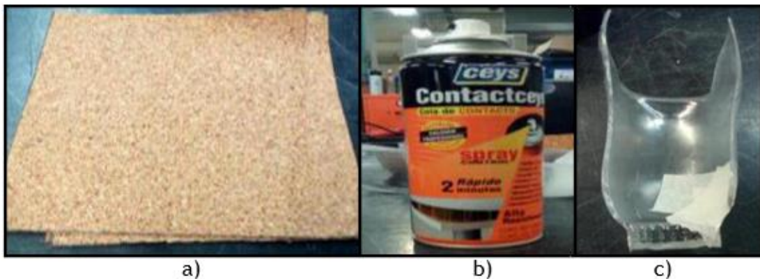
Figura 6.24 – Alguns materiais utilizados na fabricação da peça de extensão. a) cortiça, b) cola em spray e c) metade do encaixe em termoplástico.
