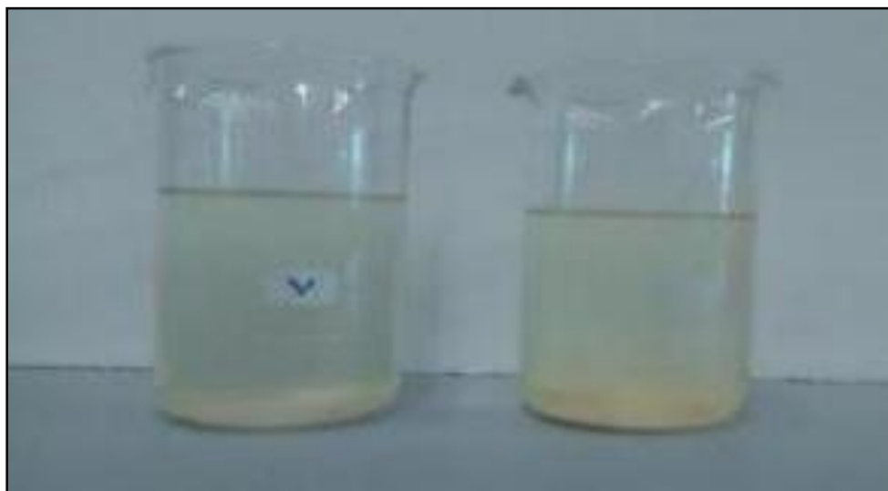
Figura 7.23—Resultado do ensaio de absorção de água pelo compósito, após imersão de 24h.
