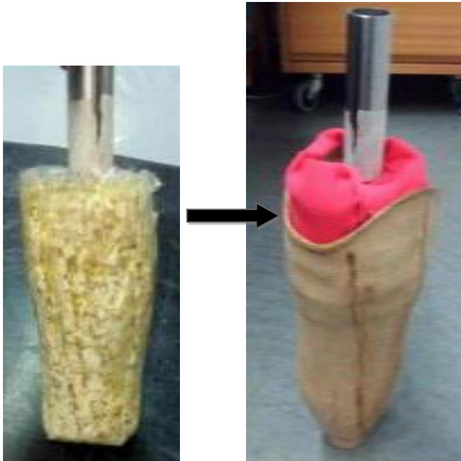
Figura 6.27 – Montagem da peça de extensão no protótipo
