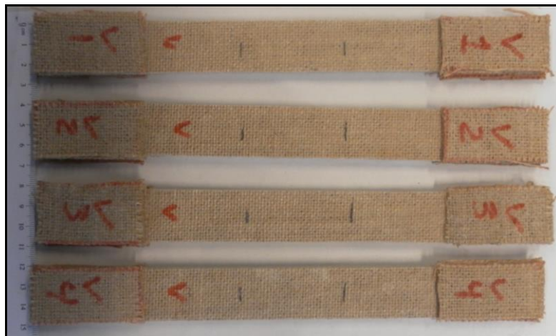
Figura 6.8 – Provetes com vinagre para ensaio de tração
