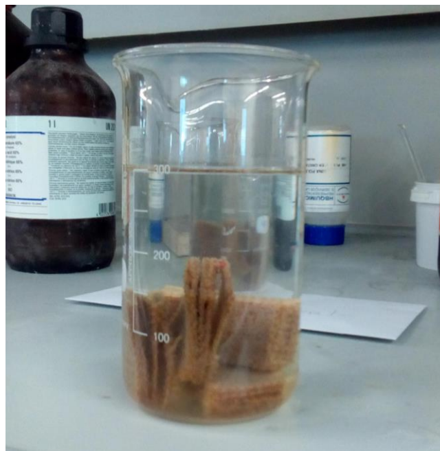
Figura 7.22 –Resultado do ensaio de absorção de água pelo compósito, após imersão de 1h.
