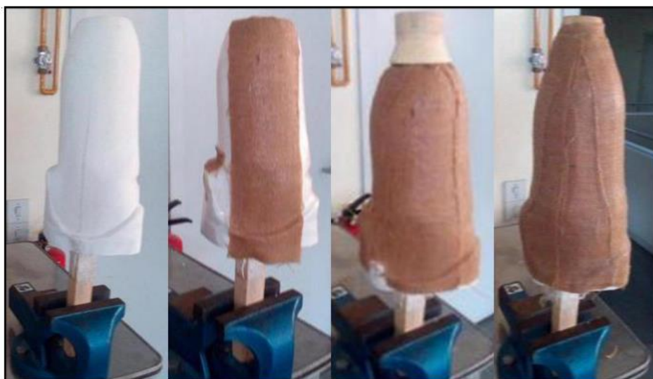
Figura 6.20 Fases de produção do encaixe
