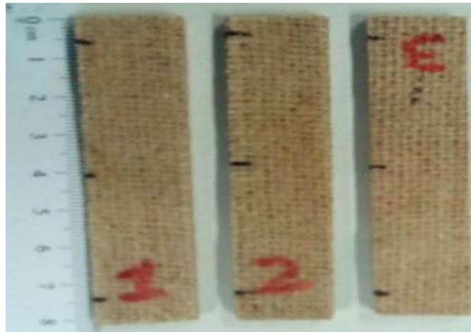
Figura 6.6 – Provetes sem vinagre para ensaio de flexão
