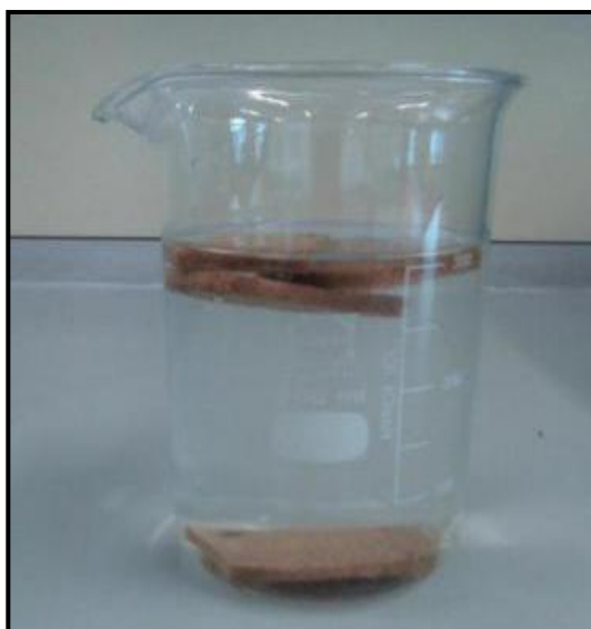
Figura 6.33 – Imersão dos provetes sem vinagre
