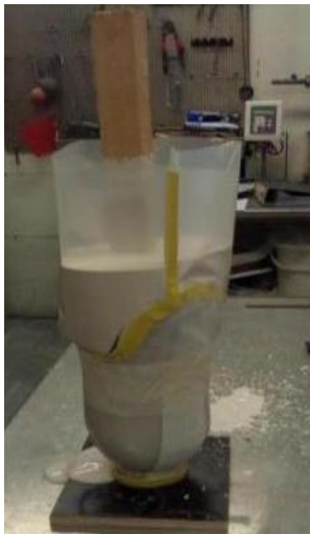
Figura 6.12 – Molde negativo com gesso
