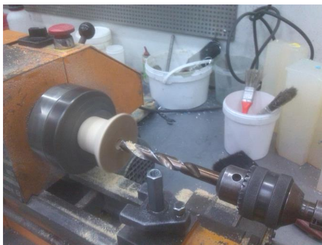
Figura 6.18 – Perfuração da peça
