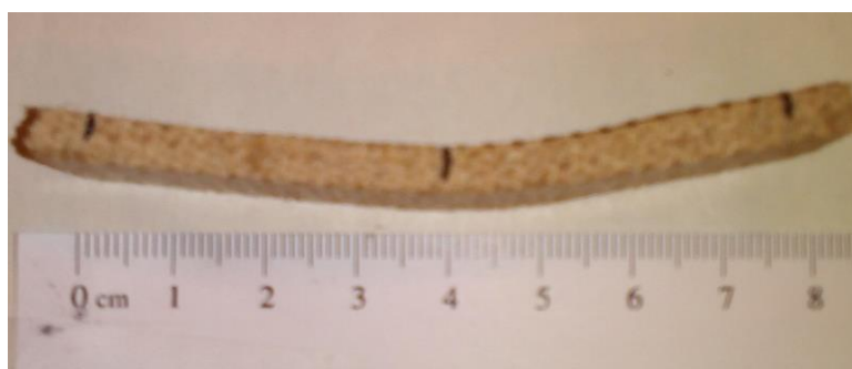
Figura 7.9 – Provete após ensaio de flexão
