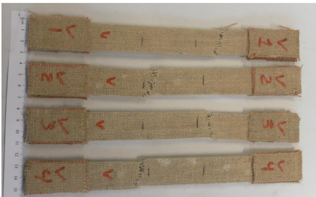
Figura 7.18 – Provete após ensaio de tração
