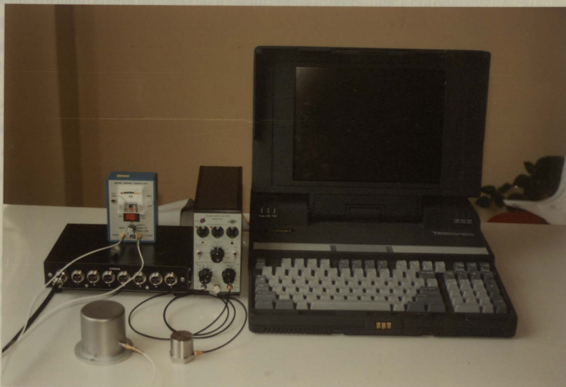
Figura 3.18 - Subsistema de medição de vibrações da FEUP.
