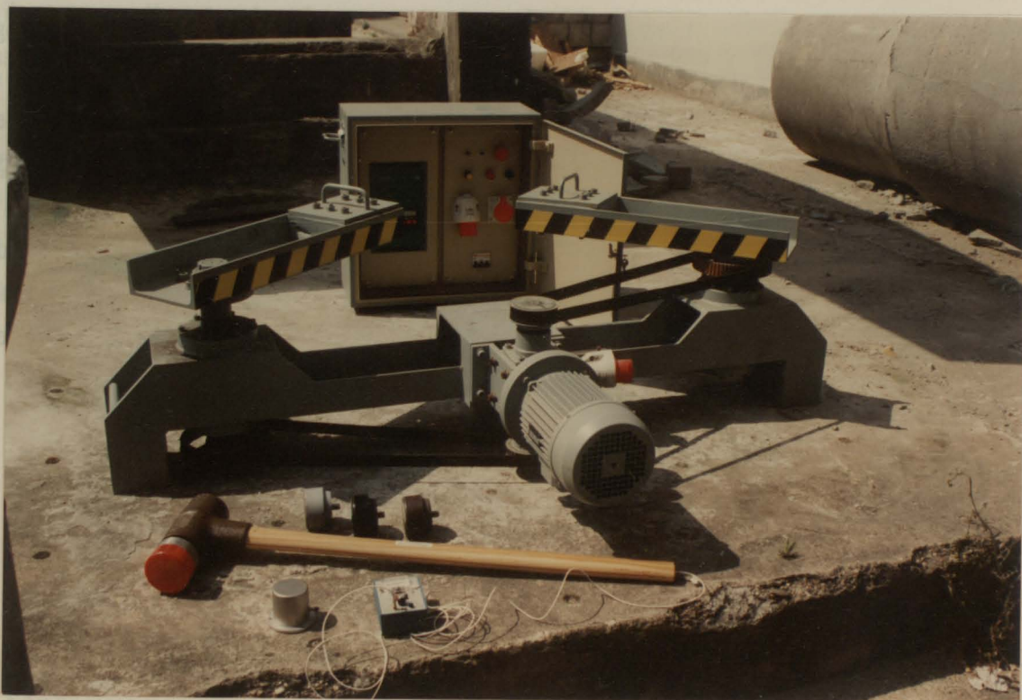
Figura 3.19 - Vibrador mecânico de massas excêntricas, martelo de impulsos e acelerómetro PCB.
