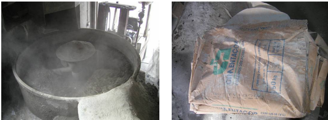
Figura 4.5 – Mistura dos agregados de bagaço com o ligante.
