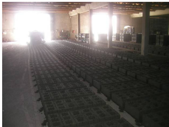
Figura 4.9 – Fabrico dos blocos.
