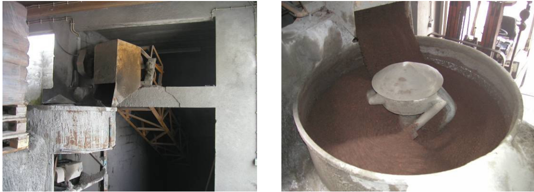
Figura 4.4 – Colocação das bagacinas na central de fabrico
