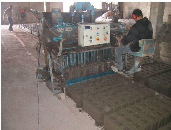
Figura 4.9 – Fabrico dos blocos.
