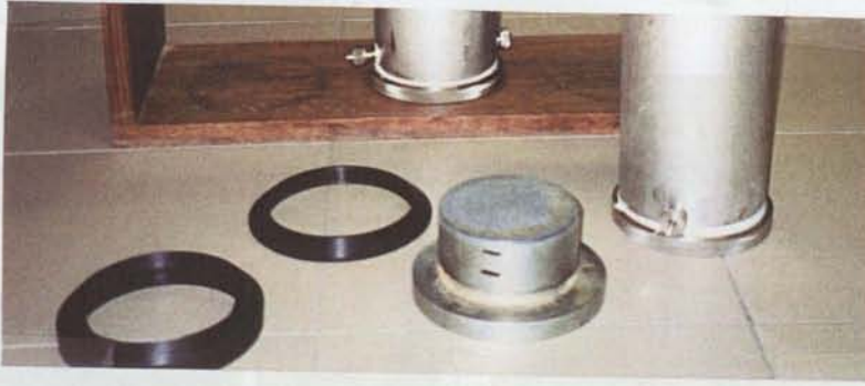
Figura 6.5 – Peças acessórias do reactor, necessárias à reconstituição de provetes. Base de compactação e protecções das extremidades do reactor durante esta fase.
