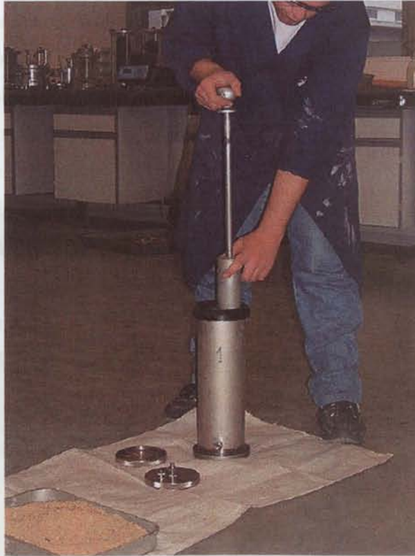
Figura 9.3 – Manobra de compactação.
