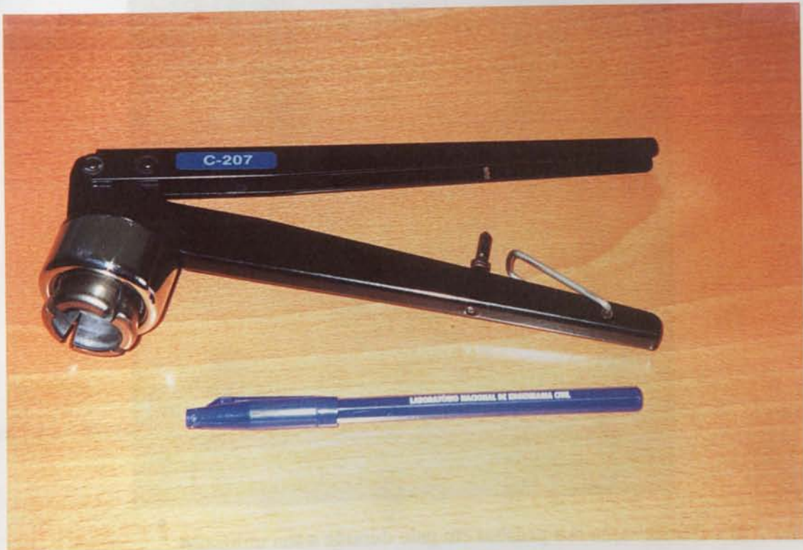
Figura 7.12 – Encapsulador utilizado na selagem dos vials.
