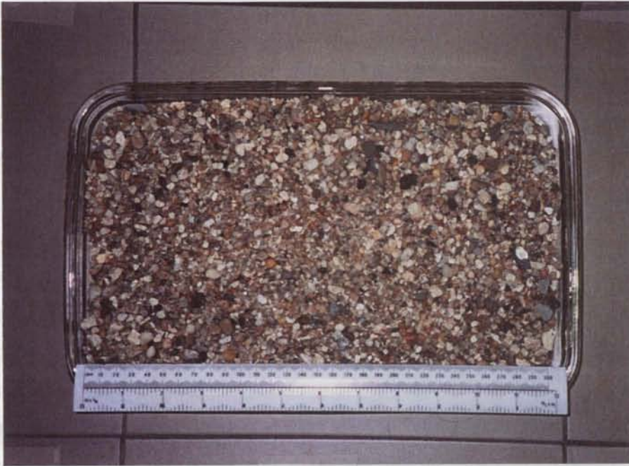
Figura 9.6 – Material granular retido no peneiro #10 e utilizado como filtro inferior.
