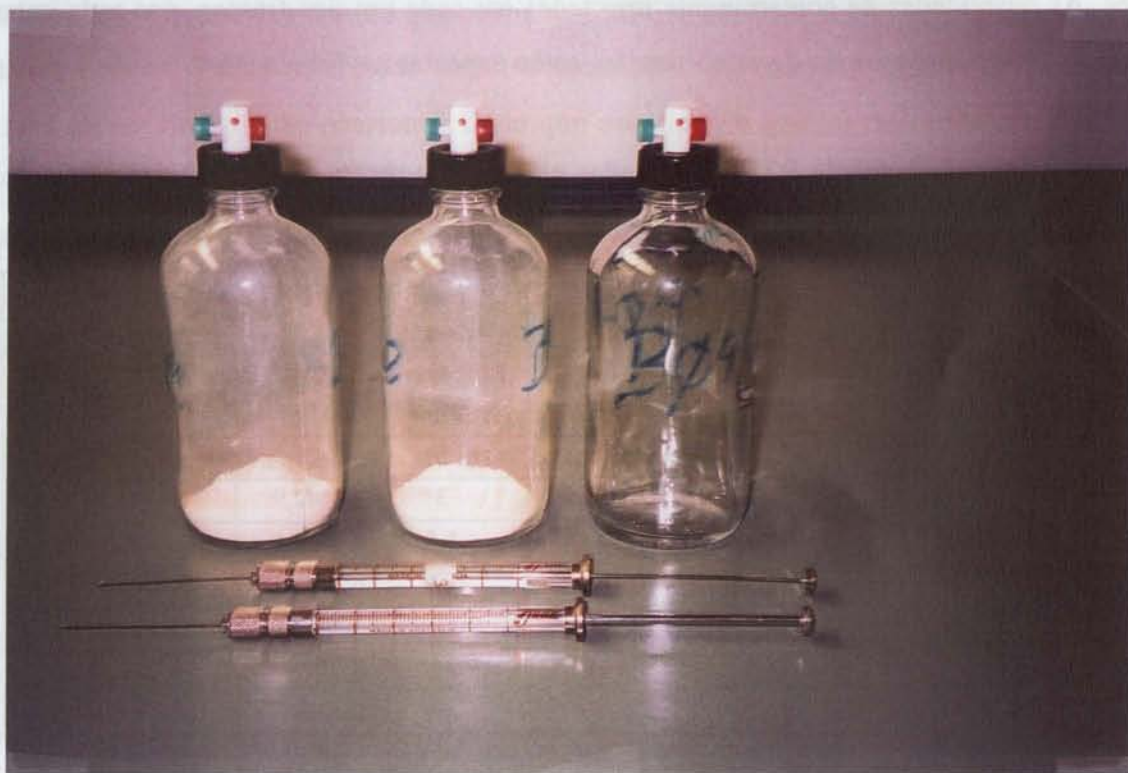
Figura 9.45 – Ensaio em frascos de 250 mL e seringas para gases com válvula de segurança.
