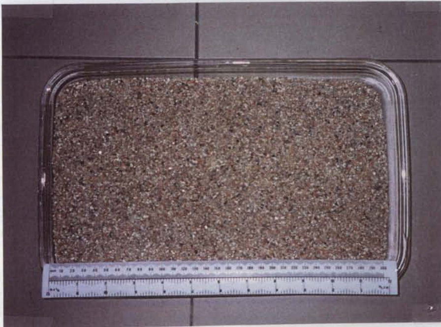
Figura 9.7 – Material granular retido no peneiro #20 e utilizado como filtro superior.
