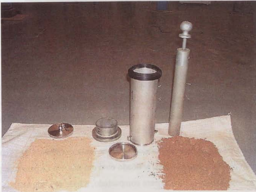
Figura 9.2 – Conjunto de compactação utilizado na preparação dos provetes de solos residuais de granito e de xisto.
