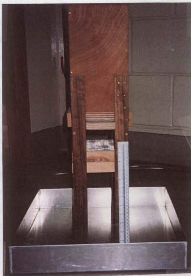
Figura 9.1 – Mini-chuveiro de areia LNEC.
