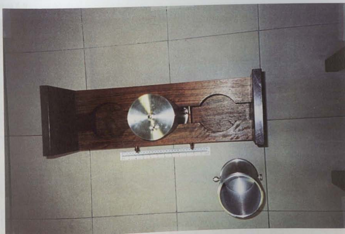
Figura 6.4 – Reactores e respectivo suporte para transporte, vistos de cima.
