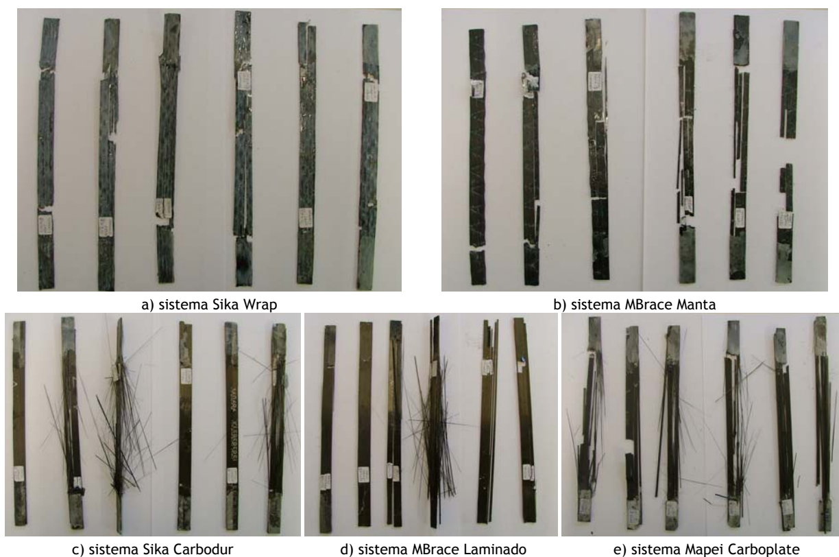
Figura 3.12 - Modos de ruína dos ensaios de tracção de sistemas de CFRP.
