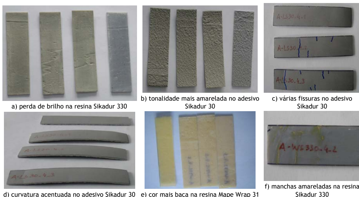
Figura 3.31 - Aspecto das alterações mais significativas nos provetes de resinas/adesivos da série IMR.
