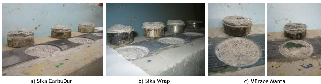
Figura 3.45 - Aspecto geral dos modos de ruína observados nos ensaios de “Pull off” [Cardoso et al., 2007].
