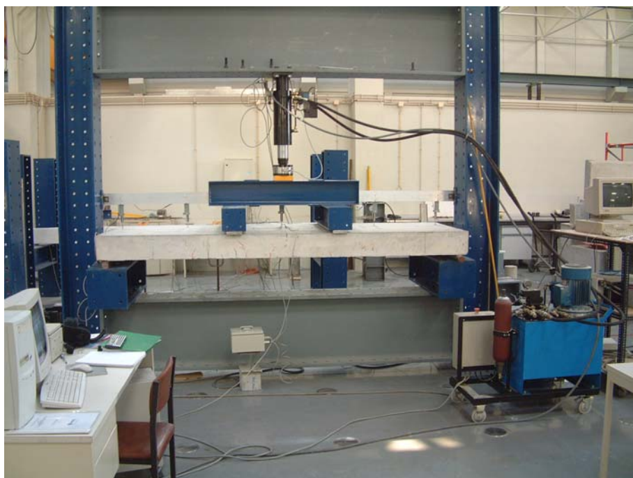
Figura B.3 – Esquema de ensaio de flexão em quatro pontos adoptado nos modelos FS.
