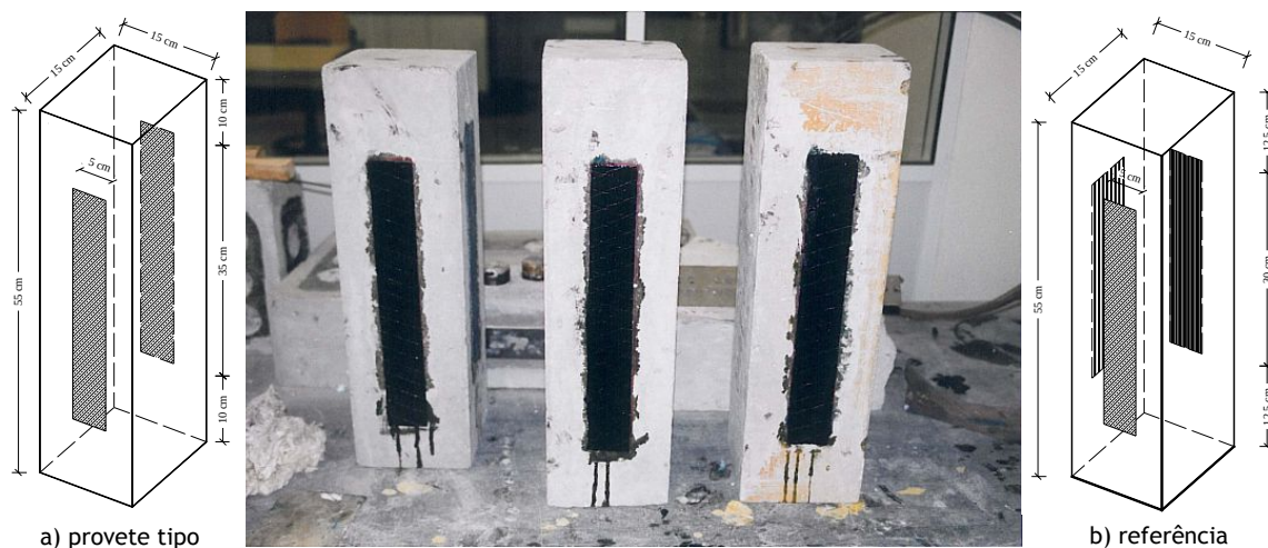
Figura 3.1 - Esquematisação dos provetes prismáticos usados nos ensaios de durabilidade.
