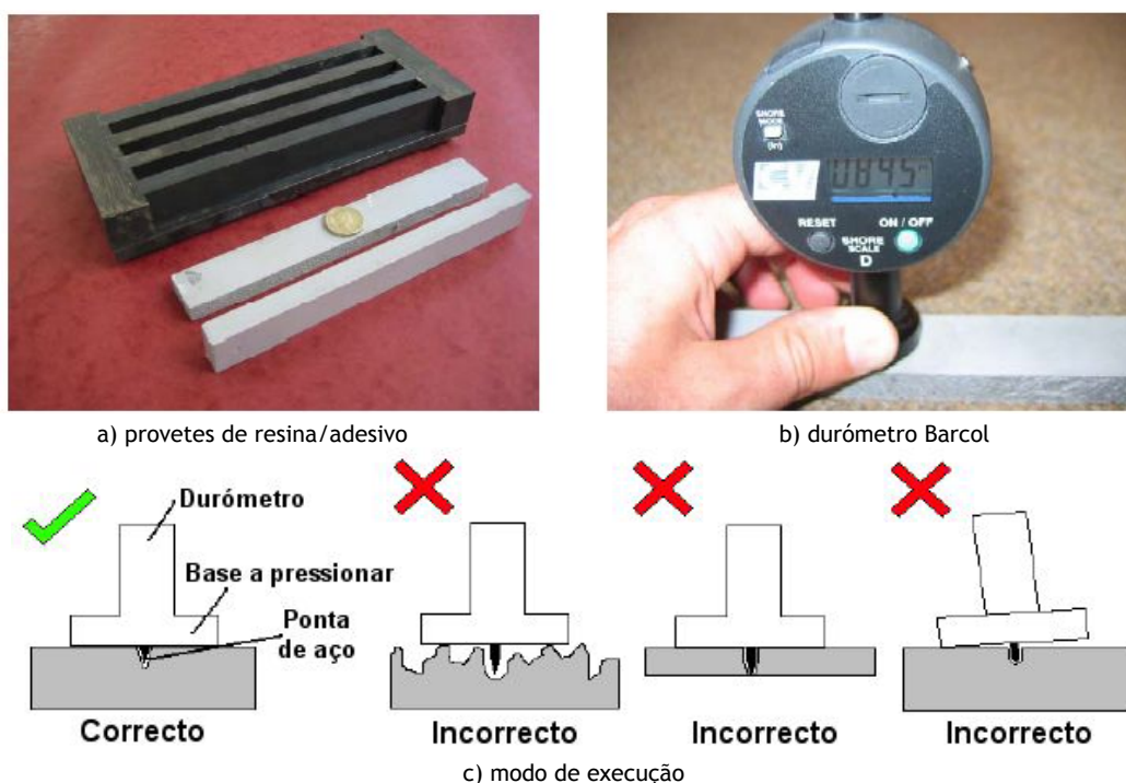
Figura 2.29 - Ensaio de Dureza Barcol para aferir o grau de cura da resina/adesivo [MM6, 2005].
