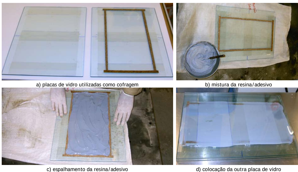
Figura A.1 - Preparação das placas de resinas/adesivos com vista à extracção de provetes.
