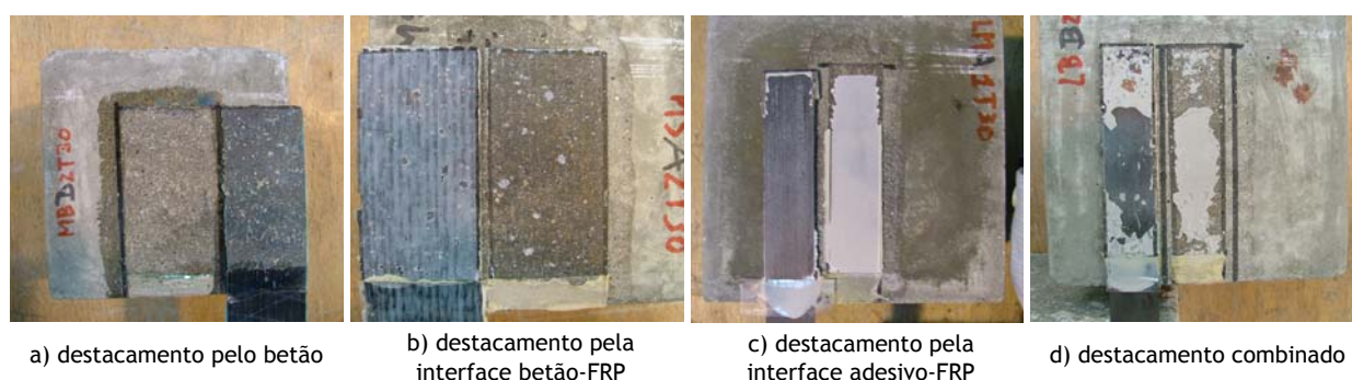
Figura 3.53 - Modos de ruína registados no ensaio de aderência em flexão dos provetes das séries M e A.
