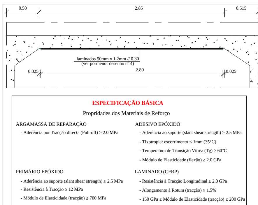
Figura 6.25 - Excerto da peça desenhada com a localização do reforço e dimensões do CFRP [Silva et al., 2006].
