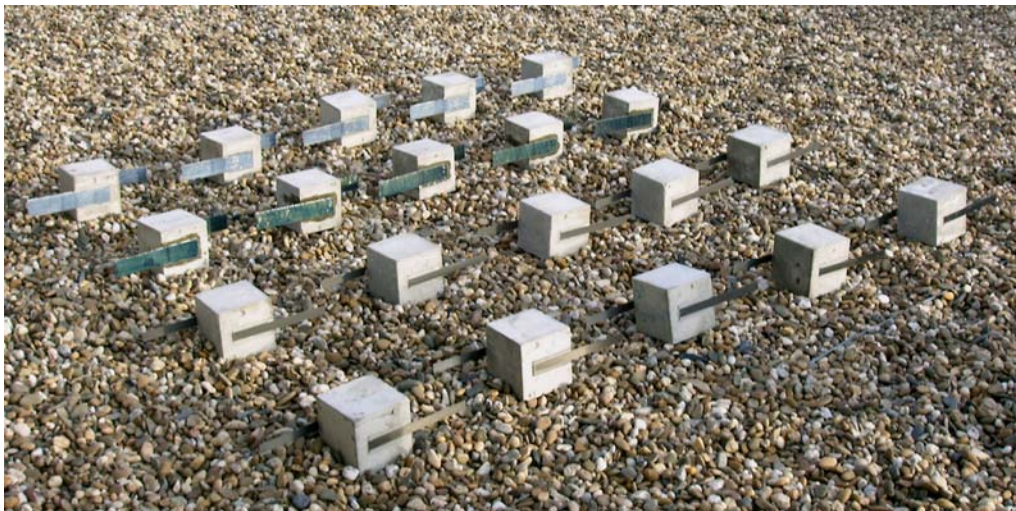
Figura 7.1 – Exposição ambiental de diversos provetes (juntas betão-compósito).
