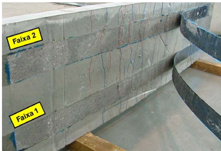
Figura 4.57 - Aspecto geral da superfície de destacamento das faixas de manta do modelo SSBM1.
