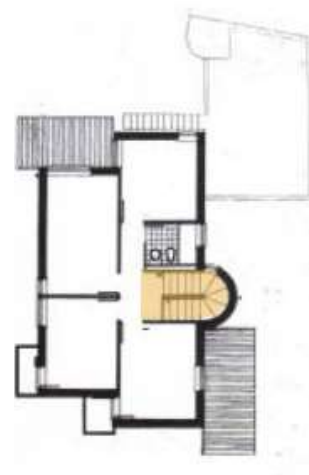
59. Saliência da caixa de escadas.
