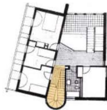
58. Saliência da caixa de escadas.
