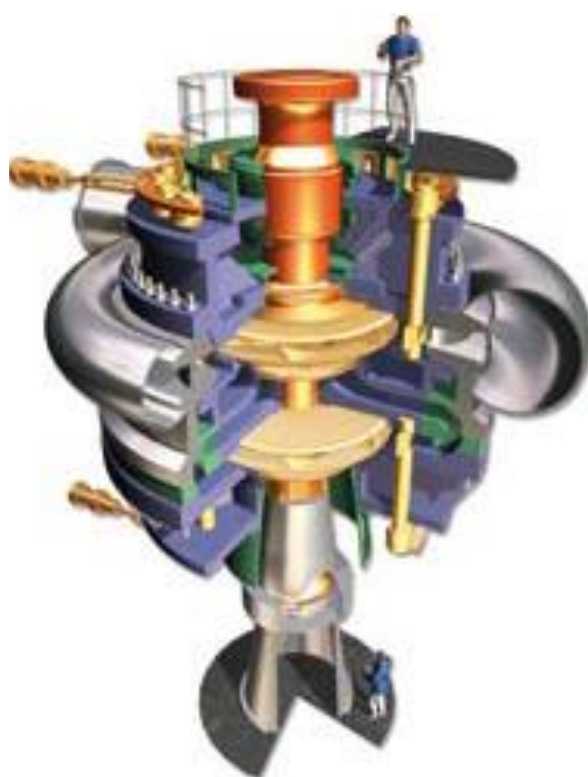
Figura 33 – Inovação Incremental – Corte transversal do grupo reversível de dois andares de Yang Yang, Coreia do Sul.
