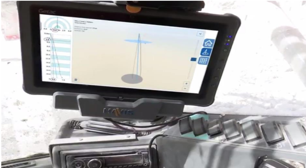
Figura 72 – Interior de uma perfuradora com sistema Robit instalado.
