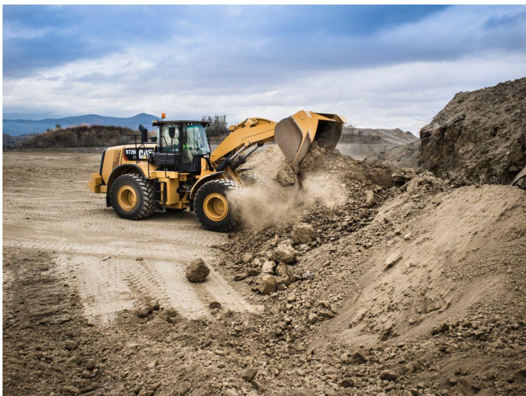
Figura 74 – Movimento de material desmontado em pilha, homogeneizando o seu conteúdo e oferecendo superfícies sucessivas da pilha com probabilidade de melhor representatividade dos calibres dos materiais que a constituem. [21]
