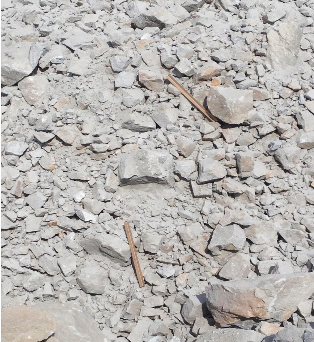
Figura 32 – Exemplo de imagem obtida após desmonte com recurso a explosivos. (Pedreira Secil, Penafiel, 2017)
