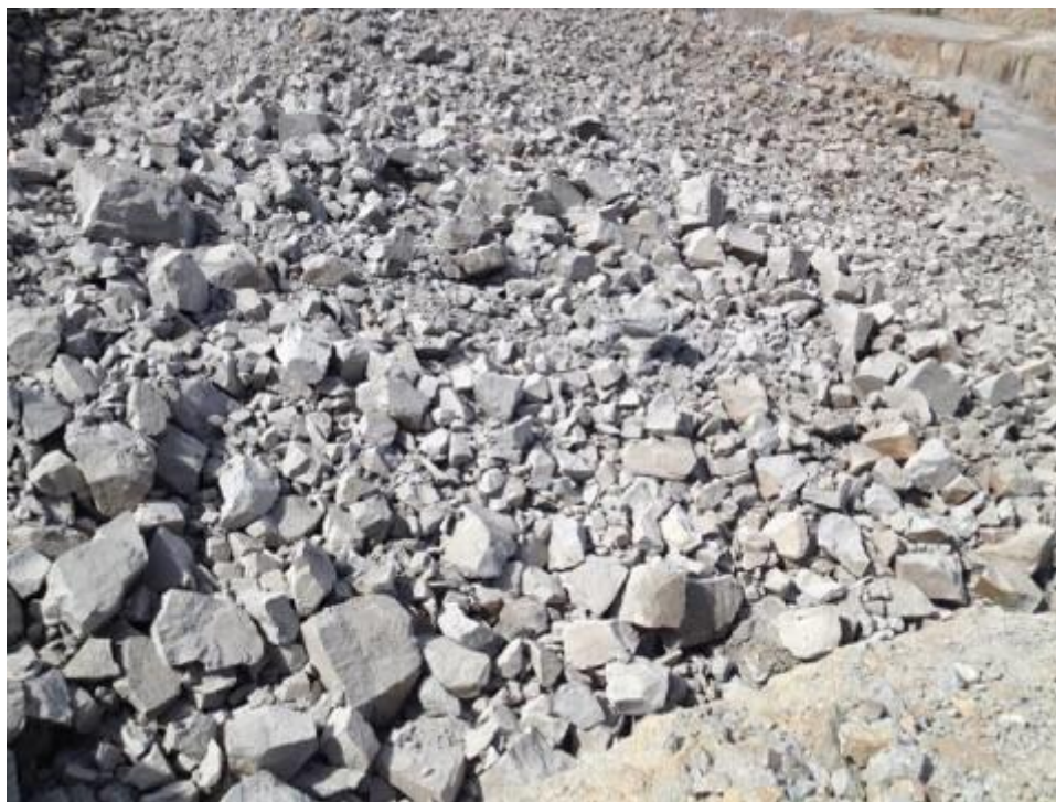
Figura 54 – Fotografia da pilha após desmonte da bancada superior.
