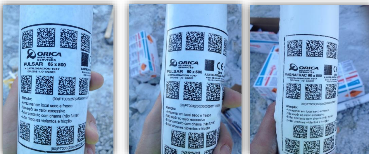
Figura 53 – Explosivos utilizados no desmorte.
