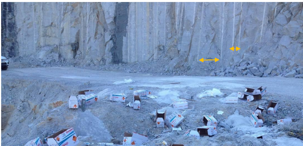
Figura 19 - Erros de direção e inclinação e comprimento dos furos.
