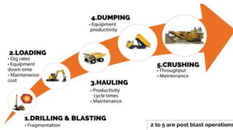
Figura 1 – Os processos de perfuração e explosão influenciam todas as fases seguintes. [1]
