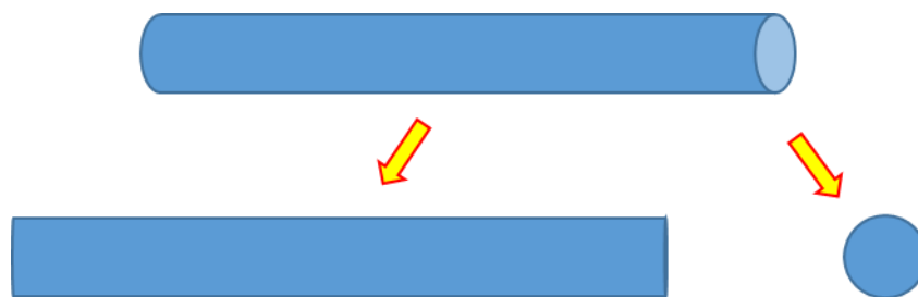
Figura 73 - Efeito da posição da partícula relativamente ao plano de observação e sua implicação na análise dimensional da mesma.
