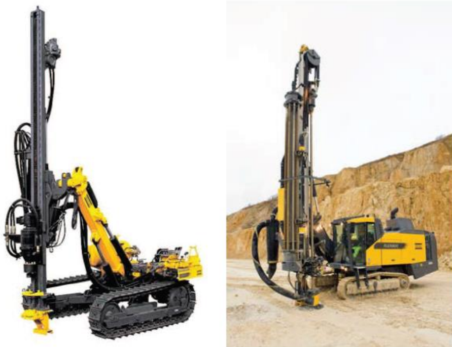
Figura 12 - Exemplos de Perfuradora com martelo Top Hammer (esquerda) e Martelo Fundo de Furo (direita). [7]
