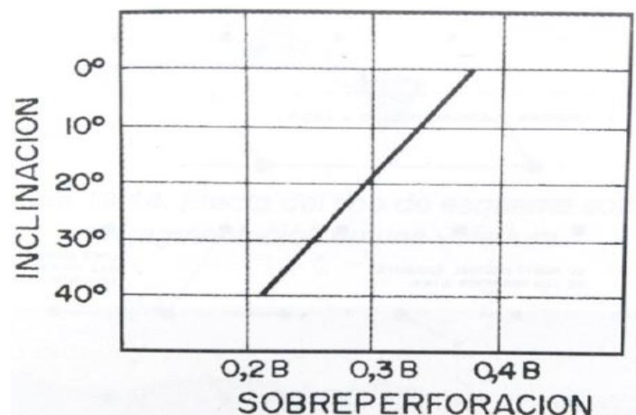
Figura 27- Relação Inclinação do furo com a Subperfuração. [11]
