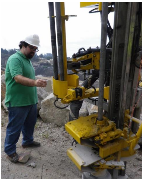
Figura 21 - Verificação de inclinação de coluna de perfuração com inclinômetro digital.
