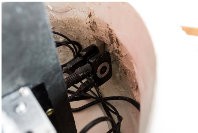
Imagens do sistema sonoro interno, com amplificadores e leitores mp3
