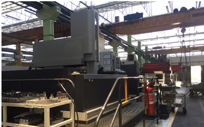
Figura 21 – Tanques de Eletroerosão
