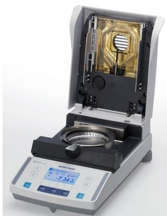
Figura 9 - Analisador de sólidos HB43-S da METTLER TOLEDO, aparelho utilizado para a determinação do teor de sólidos das tintas
