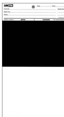
Figura 10 - Carta de contraste utilizada em todas as aplicações para determinação da opacidade, adaptada de [30]
