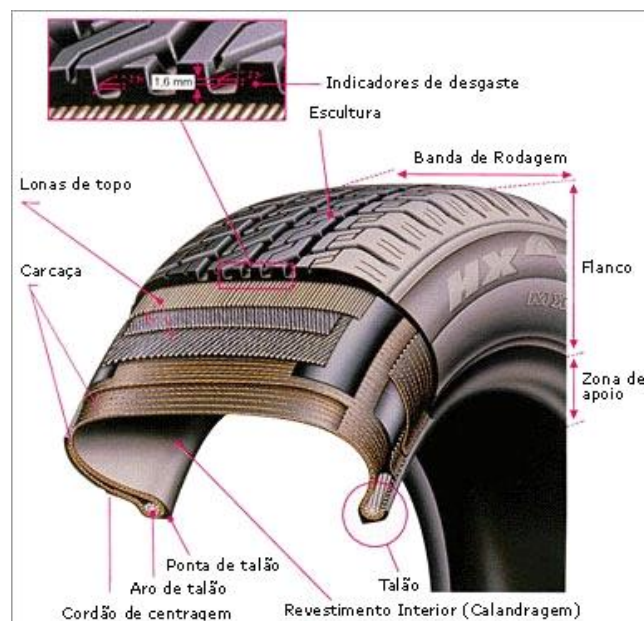
Figura 1.1 - Constituição de um pneu automotível
