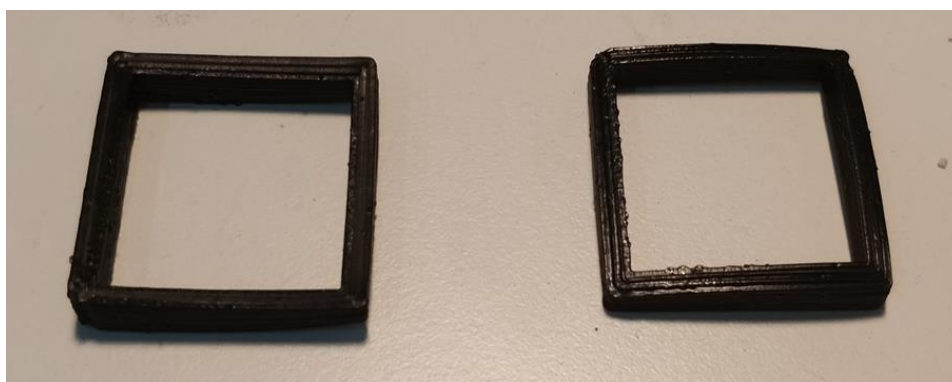
Figura 2.3 - Efeito dos gradientes de temperatura no processo de impressão
