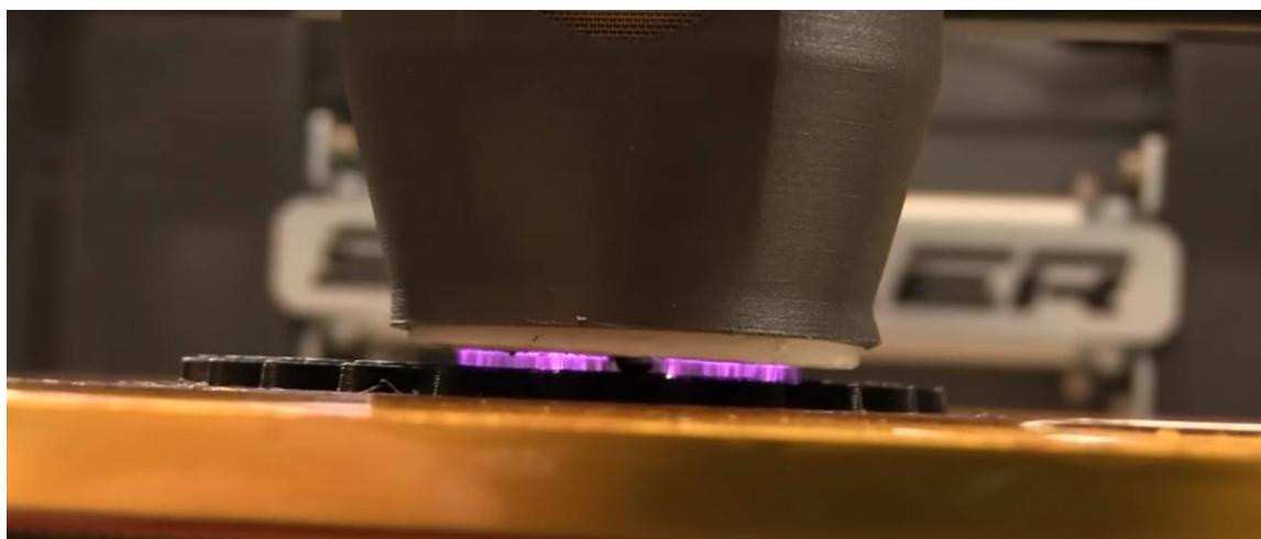
Figura 3.30 - Descargas elétricas na impressão tridimensional utilizando a tecnologia da FuseBox (Essentium 2017)
