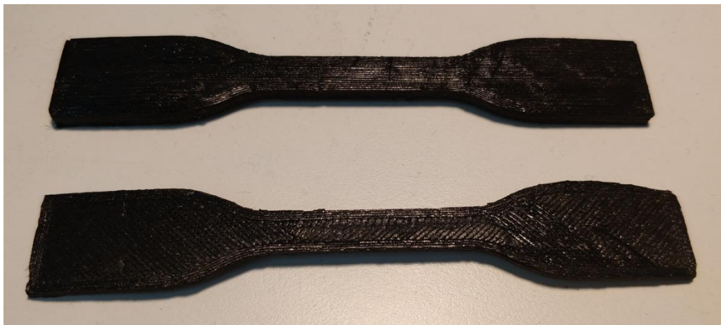
Figura 2.2 - Efeito dos gradientes de temperatura no processo de impressão.
