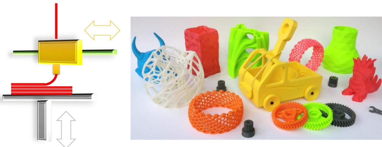
Figura 1.2 - Esquema da formação de camadas na impressão por deposição fundida (esquerda) e exemplos de impressões tridimensionais (direita) (Airwolf 3D Printers 2017)
