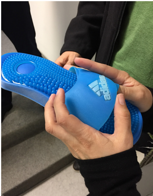
Figura 37. Compilação de imagens - protótipos produzidos através de fabrico aditivo FDM
