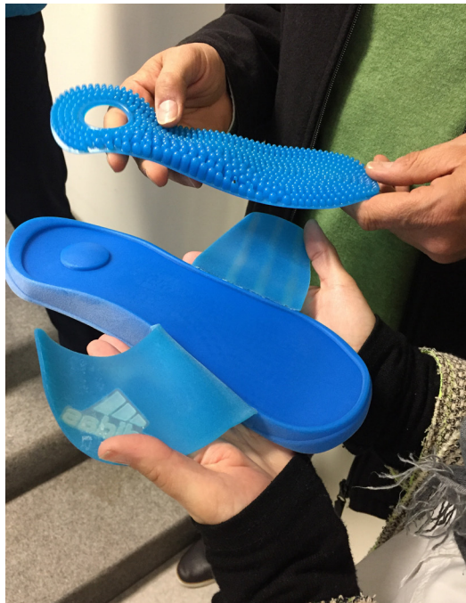
Figura 37. Compilação de imagens - protótipos produzidos através de fabrico aditivo FDM
