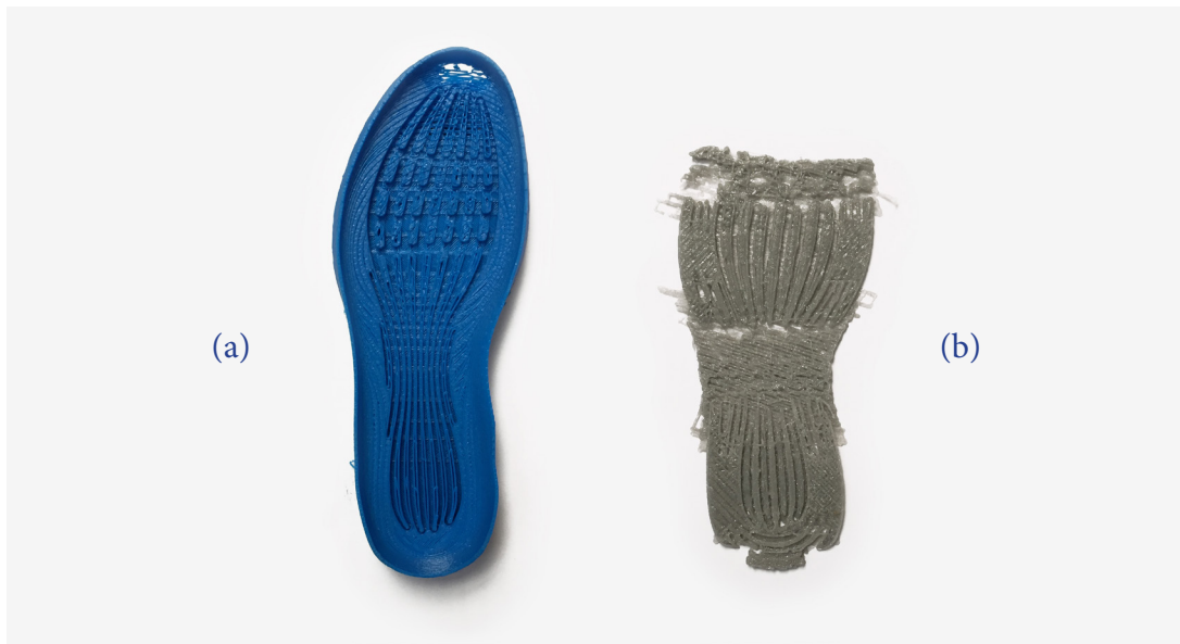
Figura 66. Tentativas de impressão da sola utilizando (a) material rígido (PLA) e (b) material flexível (TPU)
