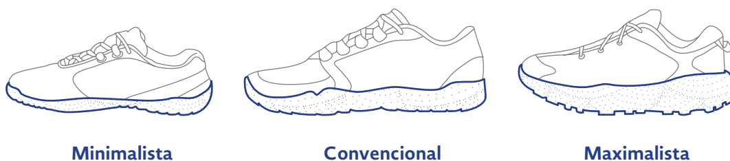
Figura 21. Níveis de amortecimento Baseado em (Sinclair et al. 2013)
