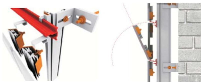
Fig. 2.29 – Ancoragem no tardo por ganchos [6]
