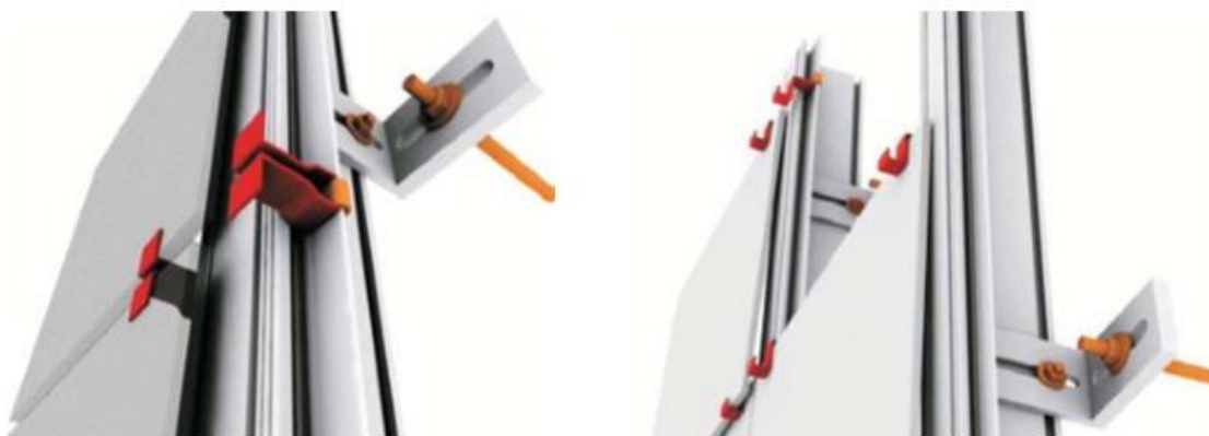
Fig. 2.24 - Ancoragem por grampos com e sem sobreposição [6]
