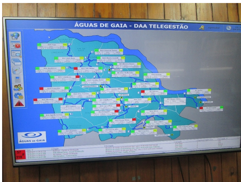
Fig.4.4. - Sistema de telegestão, tipo SCADA, da Águas de Gaia, EM, SA (18 de maio de 2017)
