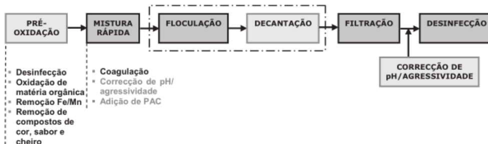
Fig.2.2. - Esquema-tipo de tratamento de água de origem superficial em Portugal (Vieira, Rosa et al., 2007)
