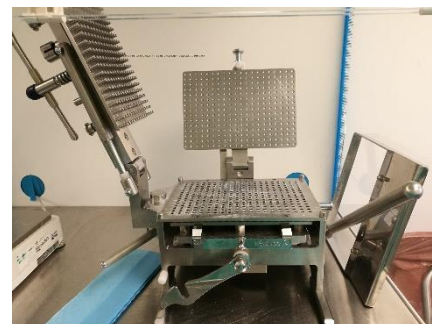
Figura 4: Encapsuladora com capacidade para 300 unidades.
