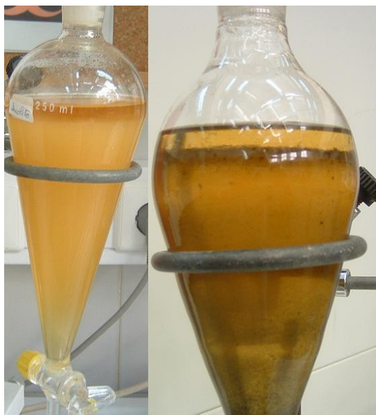
Figura 3 – Separação de fases observada nos ensaios em que foi usada: a) Duolite C-20 e b) resíduo com ZnO como catalisador. Note-se que, no caso deste último, a filtração era indispensável para remover o catalisador enquanto no caso da Duolite (e dos restantes catalisadores), a maior parte das partículas podiam ser removidas deixando-as depositar no fundo do vaso de reacção e vertendo depois a mistura para o funil de decantação.
