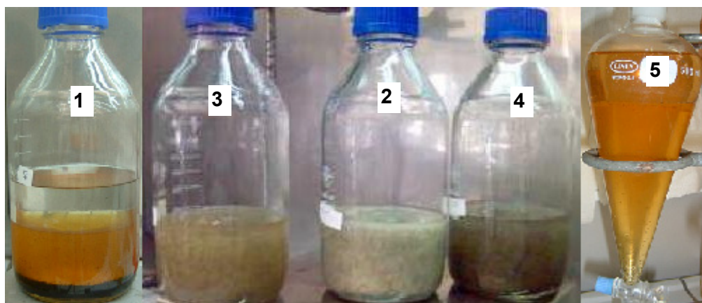
Figura 2 – Evolução do aspecto da mistura reagente na transesterificação de OAU com Amberlyst 36: 1) Antes de iniciar a agitação e aquecimento; 2) (cerca de 15 min) após o início da agitação e aquecimento; 3) mais algum tempo decorrido; 4) após 10h de aquecimento e agitação; 5) 2 fases obtidas durante o arrefecimento.
