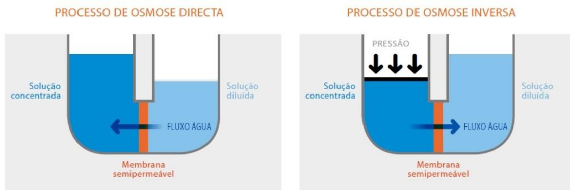
Fig. 2.5 - Esquema do processo de osmose inversa
