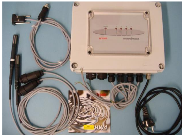
Fig. 2.18 – Data-logger , programador, sondas de temperatura e HR, bateria e cabos de ligação ao computador [3]
