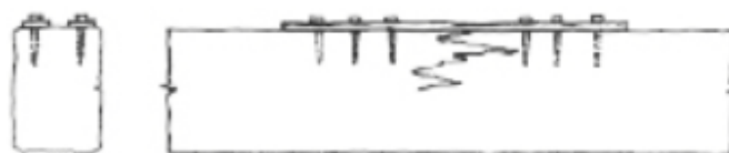
Fig. 29 – Representação de reforço com chapas metálicas, retirado de (Talone, 2010) (por sua vez retirado de (Arriaga, 2002))
