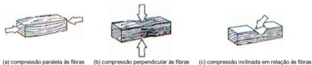
Fig. 4 – Efeitos da direção da solicitação de esforços de compressão na madeira (Szücs et al. , 2006)
