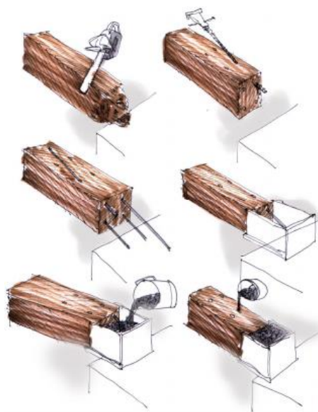
Fig. 23 – Representação do processo de introdução de varões de reforço e colocação de resina epoxídica, retirada de (Feio et al. , 2011)
