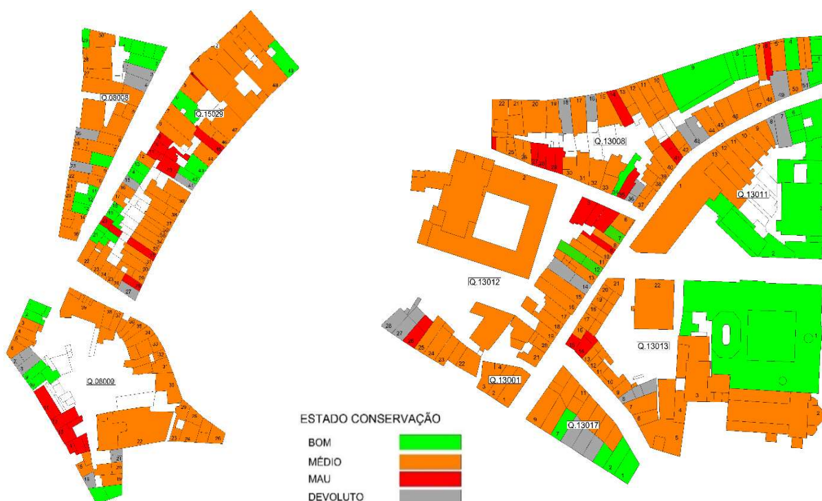
Fig. 4.9 – Estado de conservação dos edifícios da zona em estudo (à esquerda Taipas e à direita S. Francisco)
