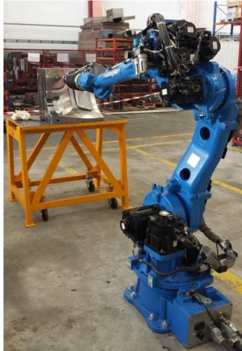
Figura 15: Robô e sistema de fixação da célula robótica da MDA.
