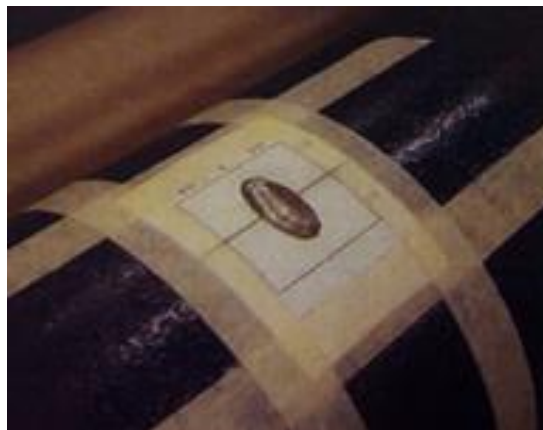
Figura 43: Representação de um defeito artificial elipsoidal.
