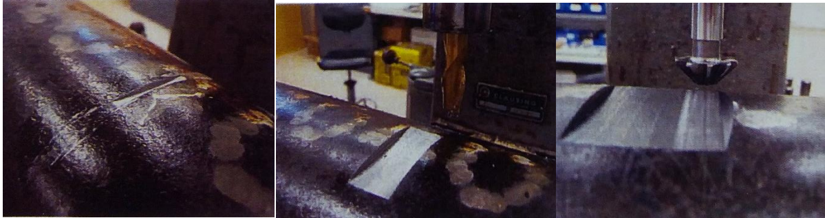
Figura 42: Entalhe maquinado com comprimento axial variável.
