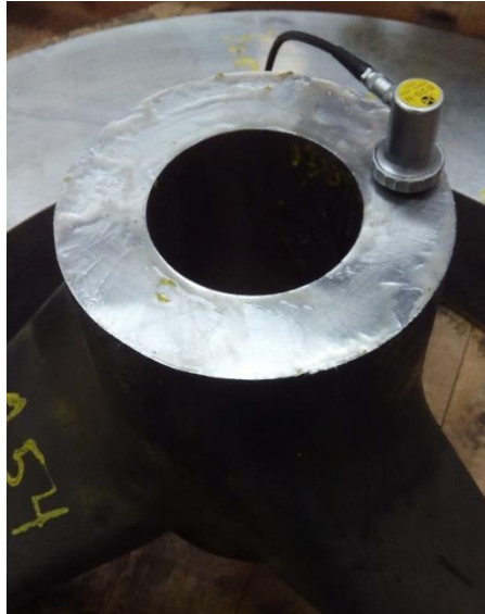
Figura 32: Representação da superfície de inspeção e sonda utilizada.
