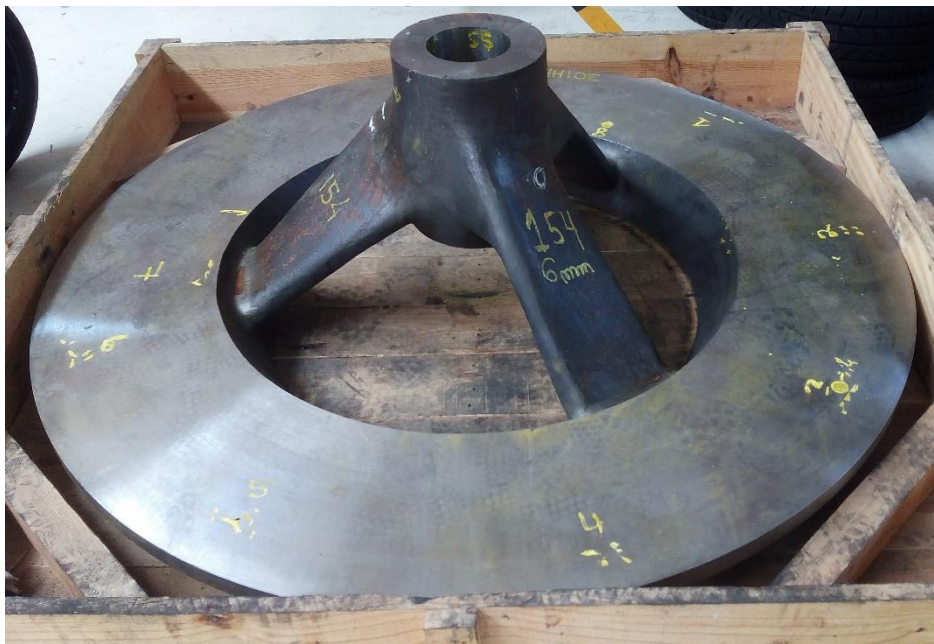
Figura 31: Peça produzida por fundição para moinho de açúcar.
