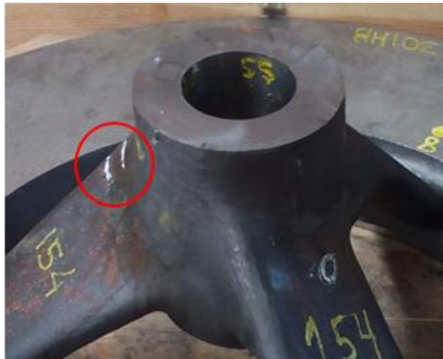
Figura 35: Posição vertical do defeito encontrado.
