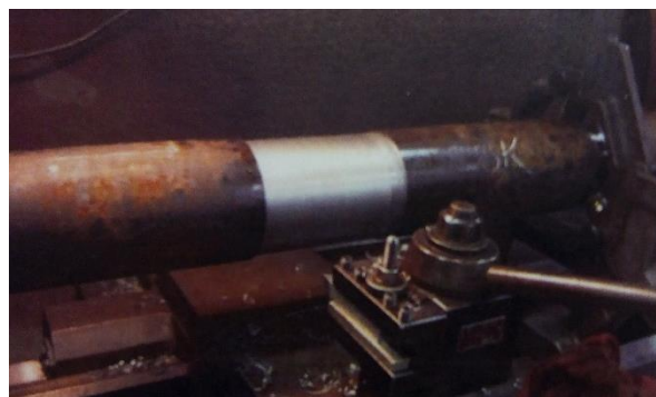
Figura 41: Entalhe circunferencial na superfície externa.
