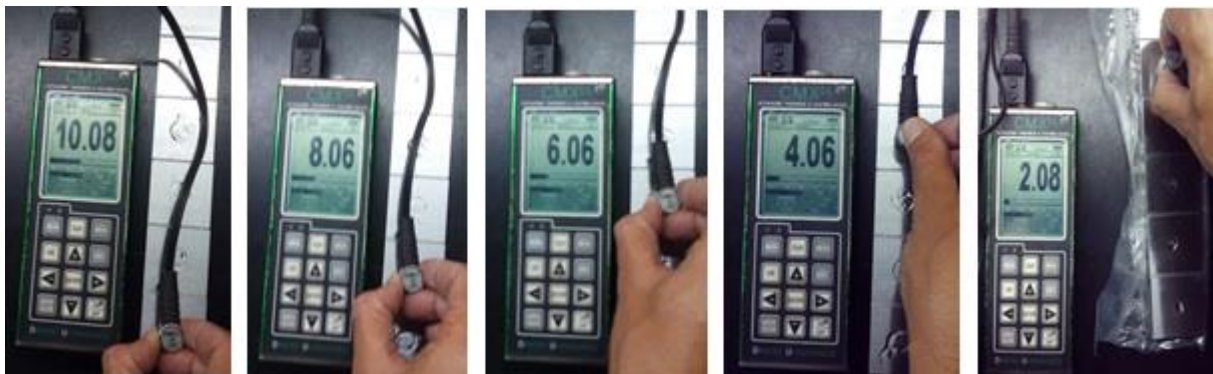
Figura 27: Verificação do estado de calibração do equipamento e da sonda.
