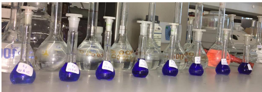
Figura 3.9: Amostras obtidas durante um ensaio de lixiviação.
