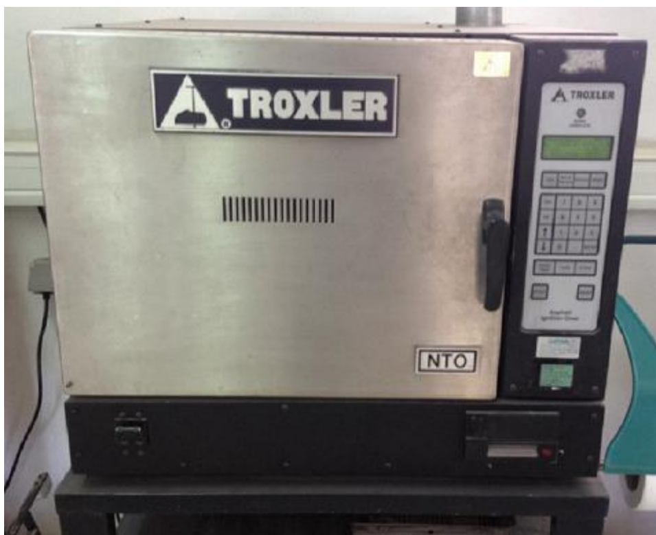
Figura 5.5 - Mufla usado para determinar a percentagem de betume
