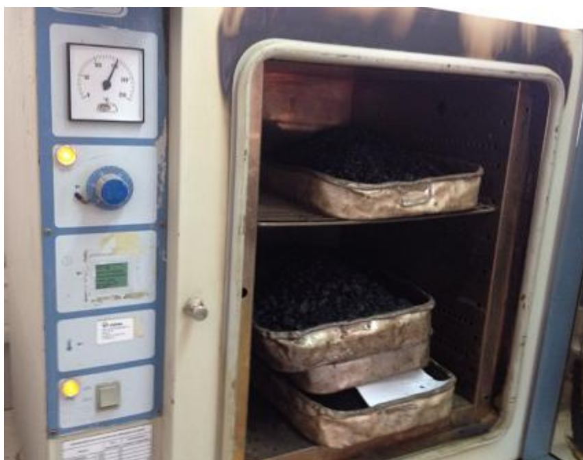
Figura 5.8 - Depois de ligeiramente arrefecida é guardada e mantida na estufa
