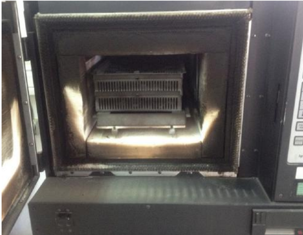
Figura 5.6 - Mufla com as cestas e a mistura betuminosa na balança interna
