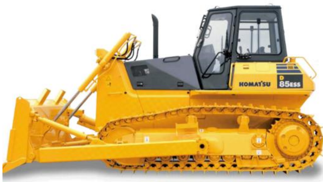
Figura 4.6 - Bulldozer utilizada nos trabalhos de desmatação e decapagem
