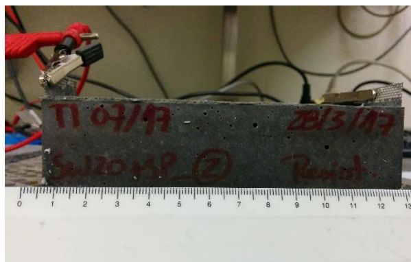
Figura 4.48 – Exemplo de ligação dos elétrodos a um provete SW20
