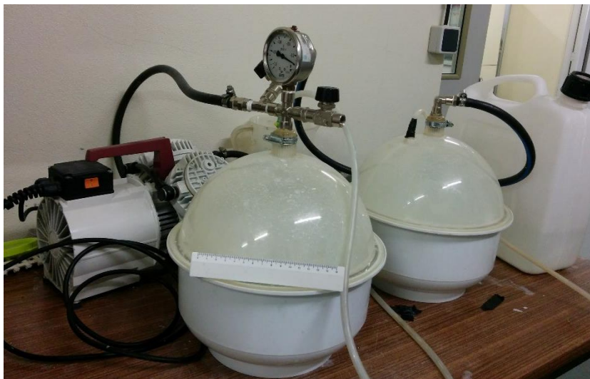
Figura 4.70 – Provetes mantidos na solução \text{Ca(OH)}_2 após desligar a bomba de vácuo
