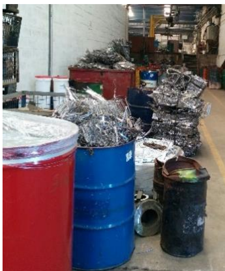
Figura 3.1 – Matéria prima de fundição: sucata variada
