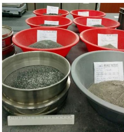
Figura 3.10 – Resultado de peneiração manual
