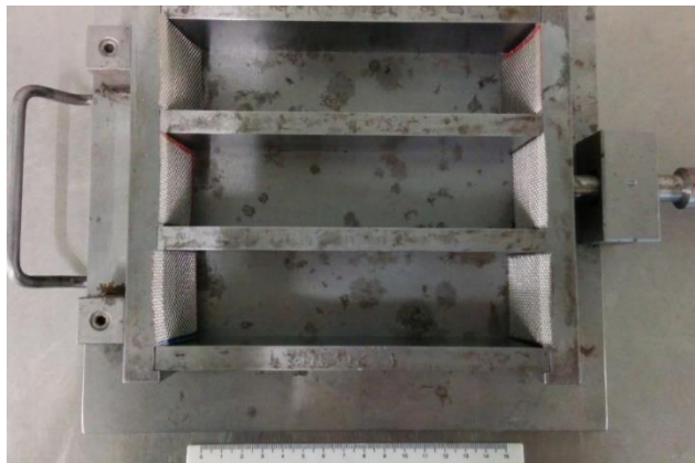
Figura 4.47 – Colocação de redesinoxidáveis nos moldes
