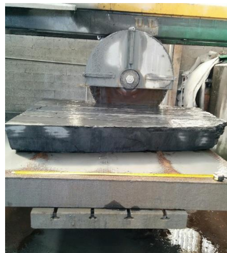
Figura 4.6 – Corte de blocos em fábrica
