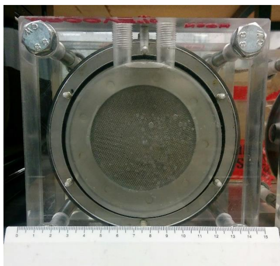
Figura 4.72 - Um dos lados da célula preenchido com solução anódica
