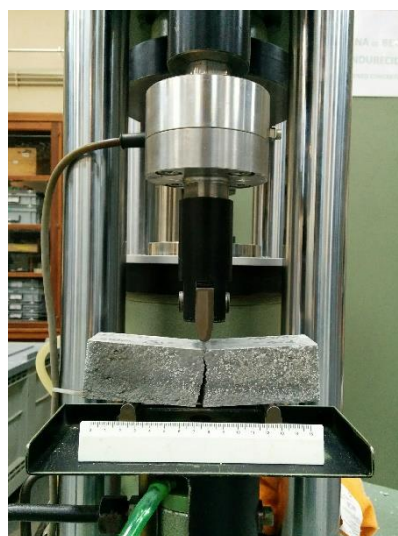
Figura 4.42 – Rotura do provete por flexão
