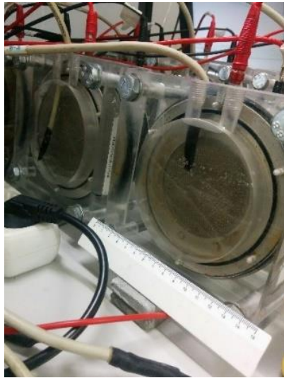
Figura 4.73 – Colocação de termómetros nos ânodos dos provetes
