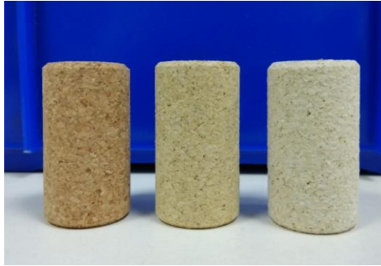
Figura 2.6-Coloração da rolha após o processo de lavação. Da esquerda para a direita, o programa utilizado é: clean0 , clear e clean 2000 .
