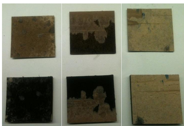
Figura 26 - Diferentes tipos de rutura observados após testes de IB, nos provetes: a) AV-021-4, b) AV-015-1 e c) AV-015-3 (da esquerda para a direita).
