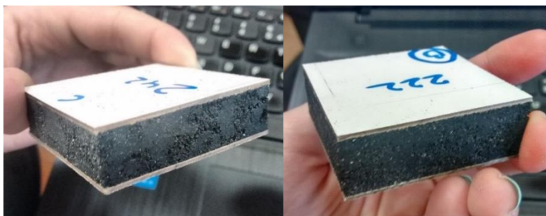
Figura 35 - Provete correspondente às placas de espessura 12,5 mm (esquerda) e 15 mm (direita).
