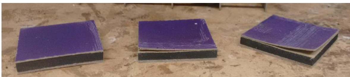
Figura 23 - Diferentes graus de delaminação resultantes do teste de água em ebulição, para os provetes AV-013, AV-012 e AV-014 (da esquerda para a direita).
