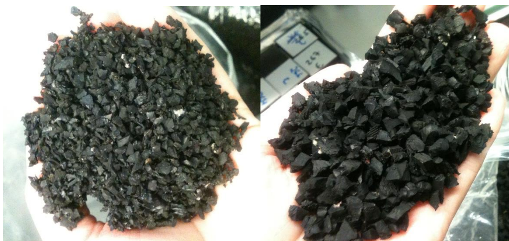
Figura 27 - Partículas de granulometria superior: 2,5-4,0 mm (esquerda) e 4,0-7,0 mm (direita).
