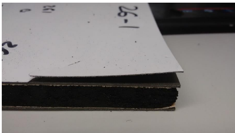
Figura 39 - Provete AV-026-1: defeitos no laminado.
