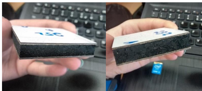
Figura 34- Provetes correspondentes às placas de espessura 7 mm (esquerda) e 10 mm (direita).
