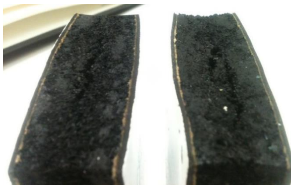
Figura 45 - Pormenor da quebra do core nos provetes AV-026-6 (direita) e AV-026-7 (esquerda).
