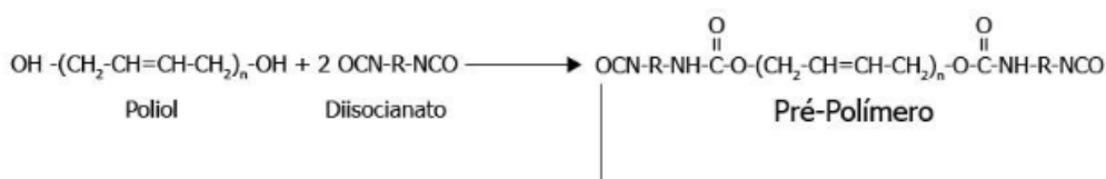
Figura 7 - Reação de formação do pré-polímero de poliuretano.
