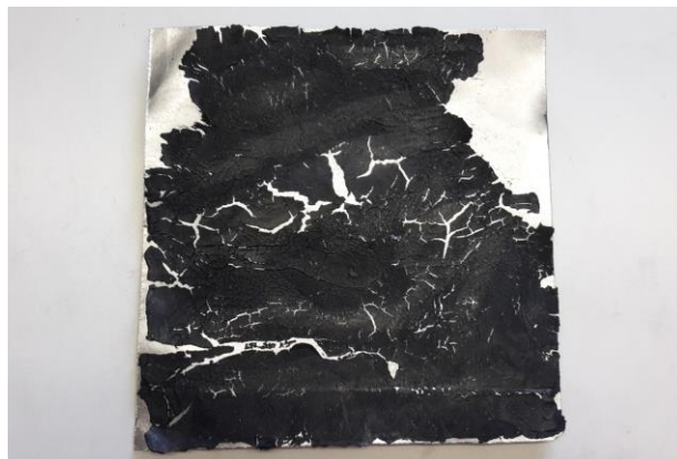
Figura 4 - Tentativa falhada da deposição da pasta de nanotubos oxidados no coletor de corrente (pasta utilizada - com moagem).
